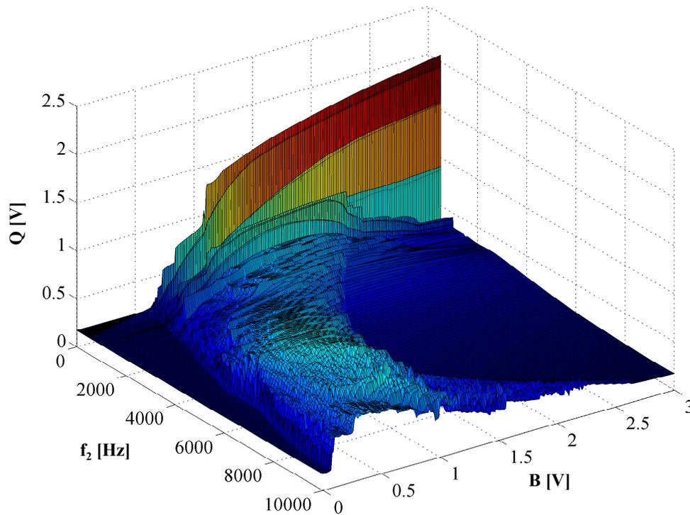
FIGURE 3.13 – Amplitude  $Q$  de la composante spectrale basse fréquence  $f_1$  de la réponse du système, en fonction de l'amplitude  $B$  et de la fréquence  $f_2$  du signal haute fréquence appliquée au système. Les simulations numériques sont obtenues pour :  $a = 2$  V,  $b = -2.6$  V,  $E_0 = -1$  V,  $A = 0.8$  V,  $f_1 = 502$  Hz,  $\gamma = 0.24$  et  $\varepsilon = 4.249$ .
