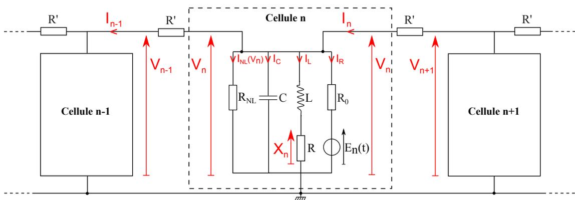
FIGURE 2.3 – Schéma synoptique de la ligne électrique de FitzHugh-Nagumo. Le circuit de la FIGURE 2.2 constitue la cellule élémentaire qui est dupliquée et couplée au moyen de résistances  $R'$ . Par souci de clarté, seule la cellule  $n$ , encadrée en pointillés, et ses deux cellules voisines  $n+1$  et  $n-1$  sont représentées sur cette figure.  $R_{NL}$  correspond à l'élément non linéaire décrit précédemment et encadré en pointillés sur la FIGURE 2.2.
