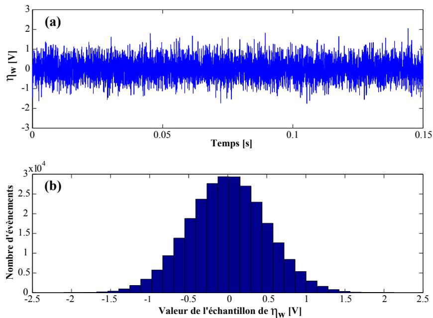
FIGURE 2.5 — Représentation temporelle (a) et histogramme (b) du bruit blanc gaussien  $\eta_w$  (pour  $\sigma = 0.5 \text{ V}_{\text{RMS}}$ ) obtenu à partir de la routine *MatLab* et relevé à l'oscilloscope via la sortie de la carte son de l'ordinateur.
