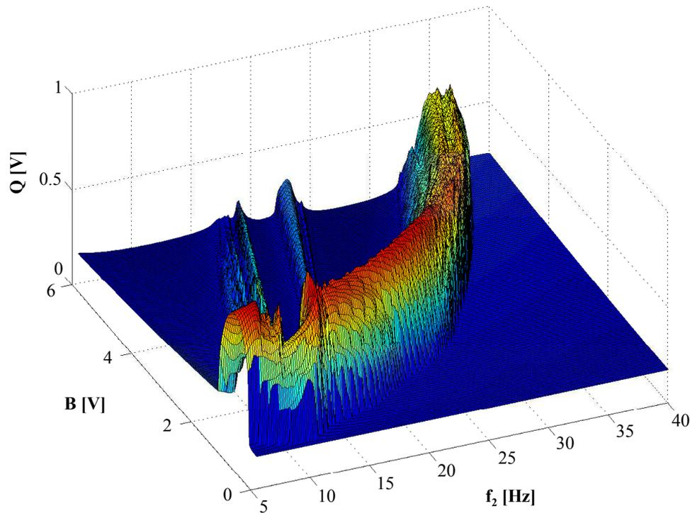
FIGURE 3.16 – Évolution de l'amplitude  $Q$  de la composante spectrale basse fréquence  $f_1$  de la réponse du système en fonction de l'amplitude  $B$  et de la fréquence  $f_2$  de la composante haute fréquence appliquée au système. Les simulations numériques sont obtenues pour :  $a = 2$  V,  $b = -2.6$  V,  $E_0 = -1$  V,  $A = 0.8$  V,  $f_1 = 502$  Hz,  $\gamma = 0.24$  et  $\varepsilon = 4.249$ .
