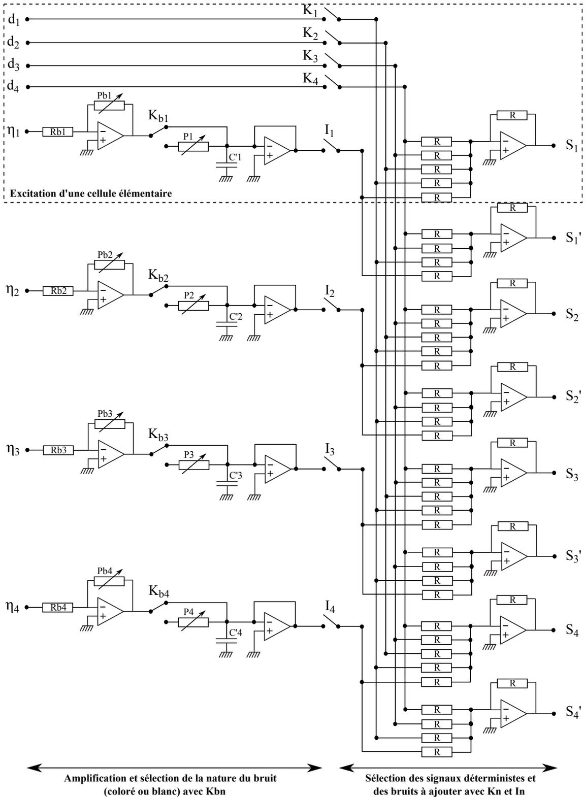
FIGURE C.1 – Schéma électrique de la carte de mixage des excitations. L'excitation  $E(t)$  nécessaire à la cellule élémentaire est générée à partir du circuit encadré en pointillés. Les excitations  $E_n(t)$  nécessaires aux cellules de la ligne électrique seront disponibles sur les huit sorties de cette carte.
