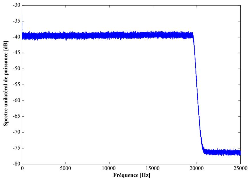
FIGURE 2.6 — Spectre unilatéral de puissance du bruit blanc gaussien  $\eta_w$  obtenu à partir de la routine *MatLab* et de valeur efficace  $\sigma = 0.5 \text{ V}_{\text{RMS}}$ . Le spectre est calculé par un moyennage sur 200 réalisations à l'aide d'un oscilloscope numérique.
