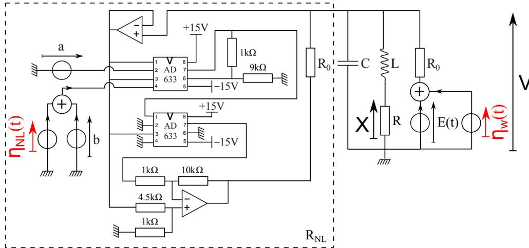
FIGURE 4.1 – Schéma électrique de l'oscillateur de type FitzHugh-Nagumo modifié pour l'étude de la résonance cohérente. Expérimentalement, pour considérer l'influence du paramètre  $\alpha$ , il a suffi de ne jamais activer les sources  $\eta_{NL}(t)$  et  $\eta_w(t)$  simultanément.
