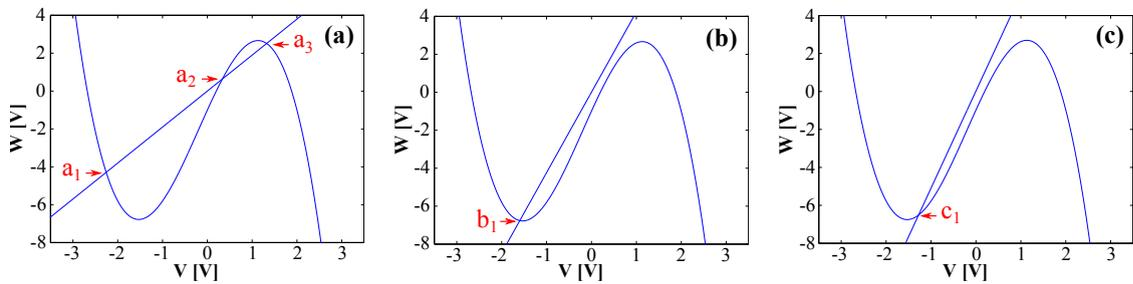
FIGURE 3.1 – Tracé des nullclines d'équations (3.3) et (3.4) du modèle de FitzHugh-Nagumo, illustrant les trois possibilités d'intersection propres à chaque régime de fonctionnement dans le cas où  $a = 2$  V et  $b = -2.6$  V. (a) : le régime bistable est obtenu pour  $\gamma = 0.53$  et  $E_0 = -1$  V. (b) : le régime excitable est obtenu pour  $\gamma = 0.236$  et  $E_0 = -1$  V. (c) : le régime oscillant est obtenu pour  $\gamma = 0.195$  et  $E_0 = -1$  V.
