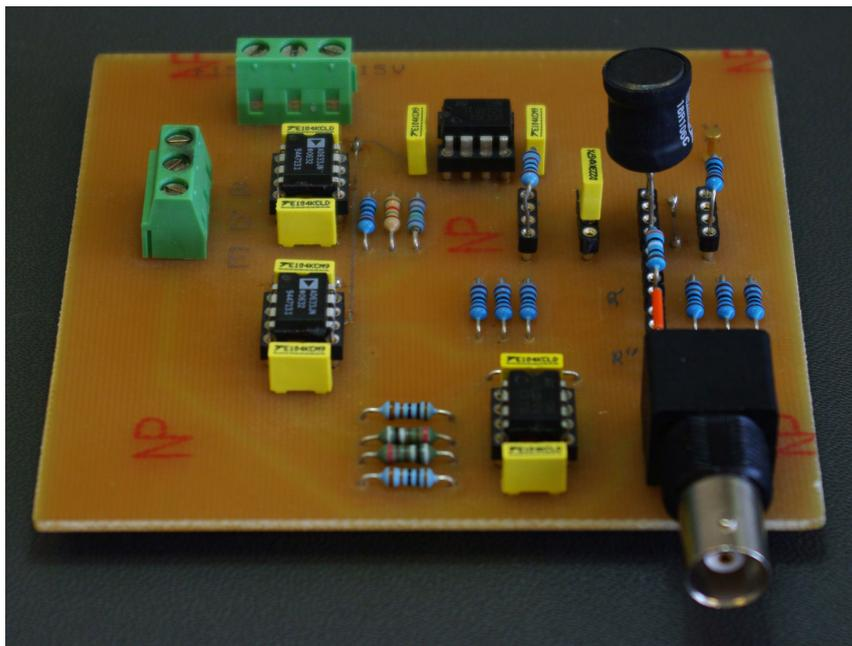
FIGURE 2.1 – Photographie de l'oscillateur électronique de type FitzHugh-Nagumo construit au début de cette thèse.
