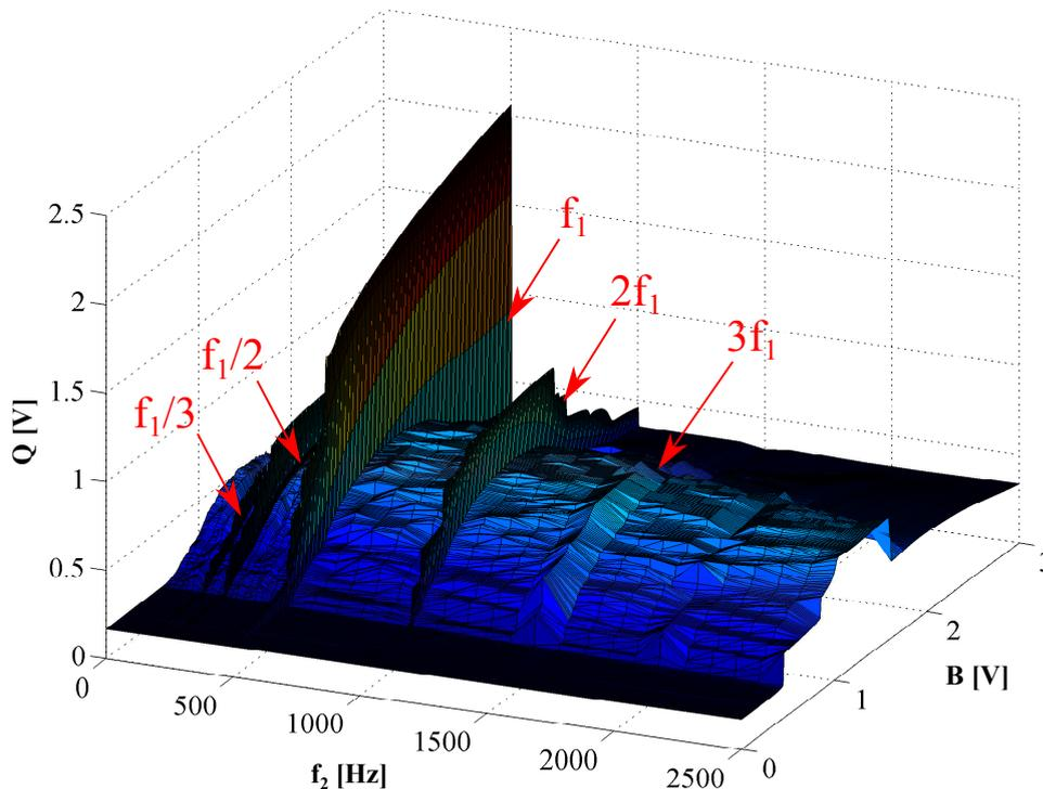
FIGURE 3.14 – Amplitude  $Q$  de la composante spectrale basse fréquence  $f_1$  de la réponse du système en fonction de l'amplitude  $B$  et de la fréquence  $f_2$  du signal haute fréquence. Les fréquences  $f_2$  favorables à l'apparition de la résonance fréquentielle sont repérées au moyen d'indicateurs. Les simulations sont obtenues pour  $a = 2$  V,  $b = -2.6$  V,  $E_0 = -1$  V,  $A = 0.8$  V,  $f_1 = 502$  Hz,  $\gamma = 0.24$  et  $\varepsilon = 4.249$ .
