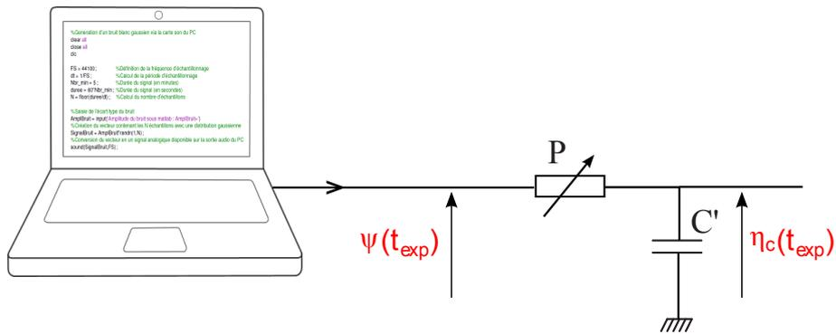
FIGURE 2.7 – Principe de génération expérimentale d'un bruit coloré de type Ornstein-Uhlenbeck.  $\eta_c(t_{exp})$  est obtenu en filtrant un bruit blanc  $\psi(t_{exp})$  avec un filtre passe-bas du premier ordre réalisé avec un potentiomètre  $P$  et un condensateur  $C'$ .
