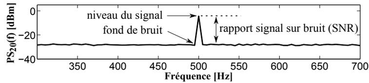
FIGURE 5.10 – Principe d'estimation du rapport signal sur bruit.
