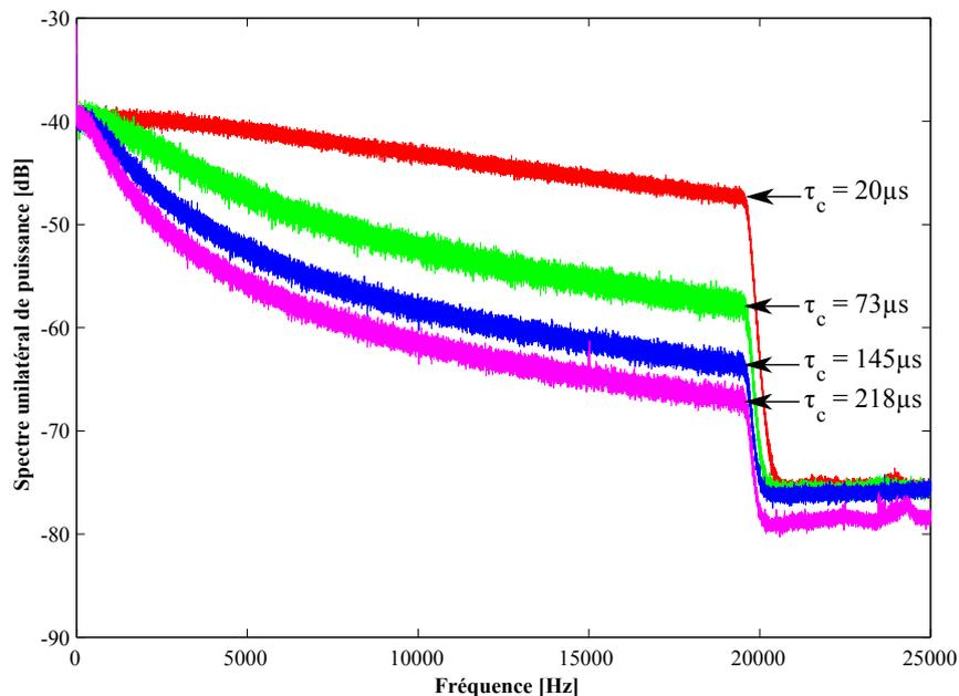
FIGURE 2.8 – Spectres unilatéraux de puissance des bruits colorés obtenus après filtrage du bruit blanc pour quatre temps de corrélation, à savoir  $20 \mu\text{s}$ ,  $73 \mu\text{s}$ ,  $145 \mu\text{s}$  et  $218 \mu\text{s}$ . Comme précédemment, les spectres sont calculés par un moyennage sur 200 réalisations à l'aide d'un oscilloscope numérique.
