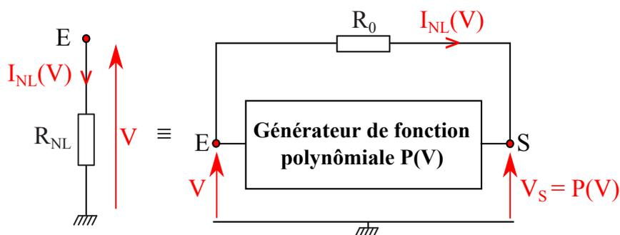
FIGURE A.1 – Modélisation de l'élément non linéaire  $R_{NL}$  de l'oscillateur de FitzHugh-Nagumo, permettant de déterminer la fonction polynômiale nécessaire à l'obtention du courant non linéaire  $I_{NL}(V)$ .
