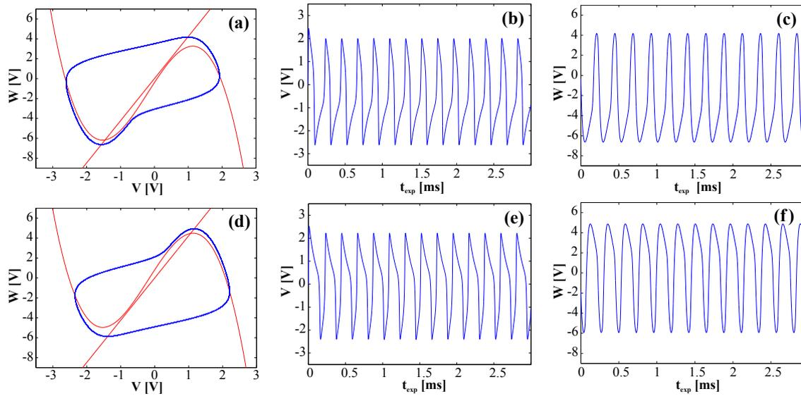
FIGURE 3.5 — Signaux obtenus en simulations numériques à la limite des bifurcations inférieure et supérieure d'Andronov-Hopf. (a), (b) et (c) : portrait de phase et allures temporelles de  $V$  et  $W$  obtenus lorsque  $E_0 = E_{c\ inf} = -0.40$  V. (d), (e) et (f) : portrait de phase et allures temporelles de  $V$  et  $W$  obtenus lorsque  $E_0 = E_{c\ sup} = +0.82$  V. Les paramètres du système sont :  $a = 2$  V,  $b = -2.6$  V,  $\gamma = 0.236$  et  $\varepsilon = 3.706$ .
