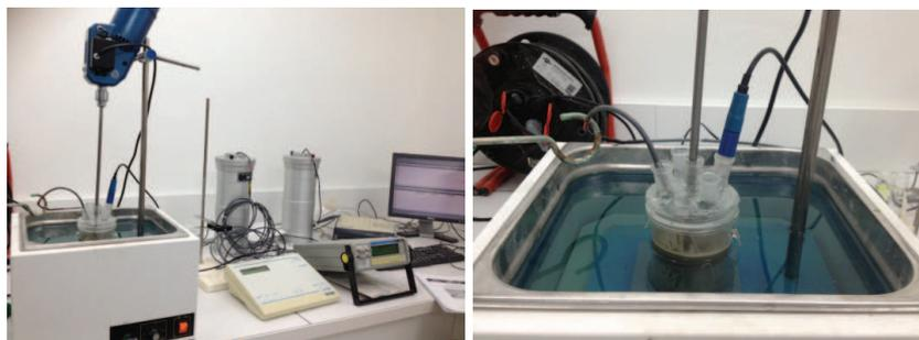
*Figure 4-4: Vue du dispositif de conductimétrie ionique.*
