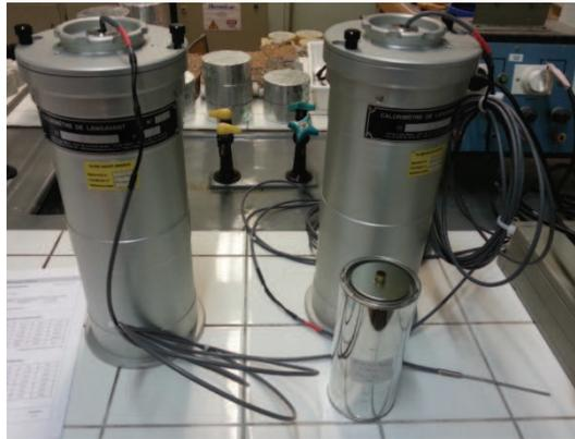
*Figure 4-3 : Calorimétrie semi-adiabatique Langavant*
