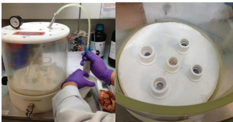
*Figure 2-15 : Préparation des échantillons pour analyse MEB*
