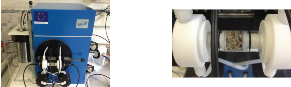
Figure 2-13 : Zetamètre de type ZetaCAD (gauche) et zoom sur l'échantillon (droite)
