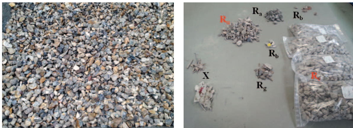
Figure 2-5 : Les résultats visuels des essais de tri sur le RB 10/20 de RECYBÉTON
