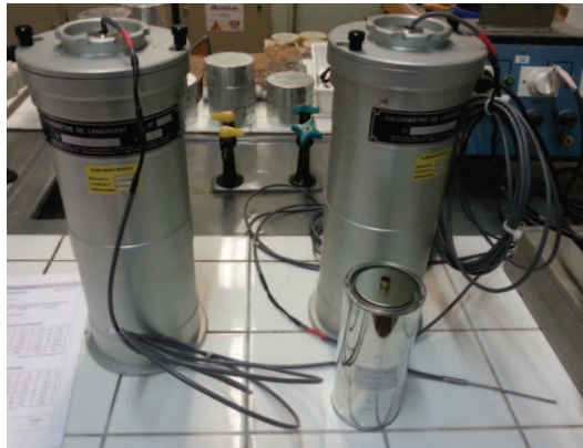
Figure 4-3 : Calorimétrie semi-adiabatique Langavant
