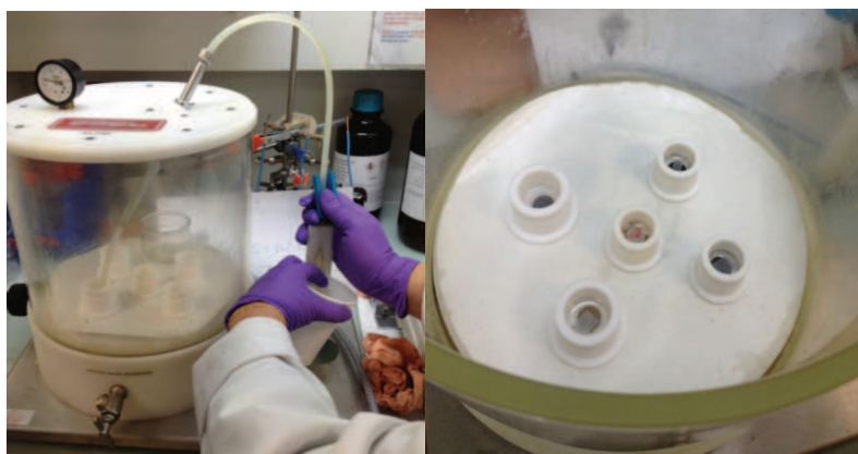
Figure 2-15 : Préparation des échantillons pour analyse MEB
