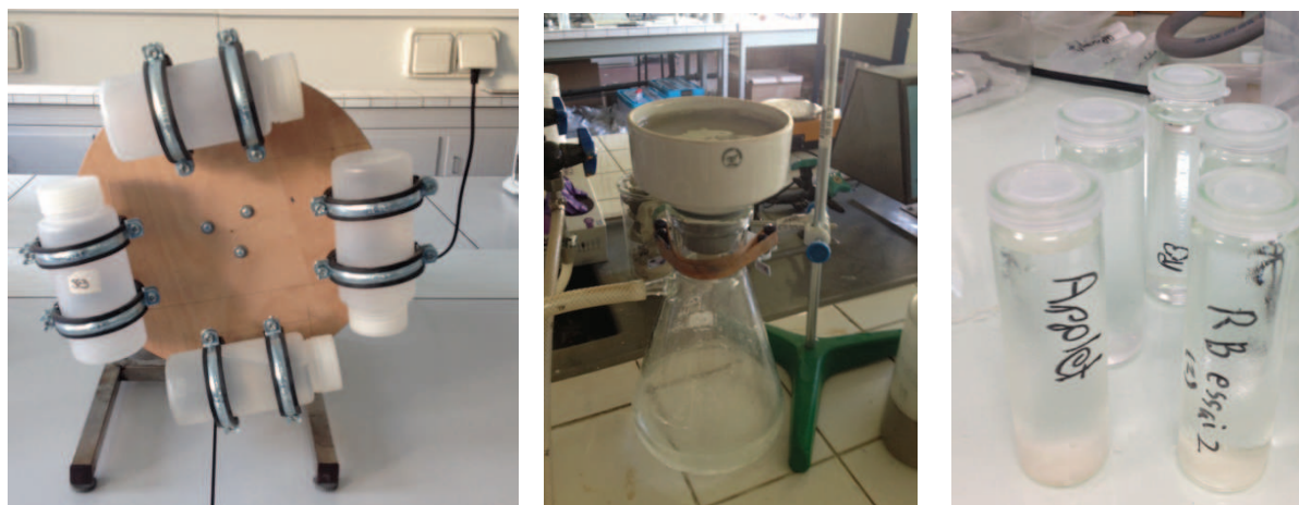
Figure 2-18 : Essai lixiviation (gauche), filtration (centre), échantillon après filtration (droite)
