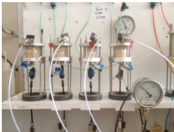
Figure 5-15 : L'essai en cours de perméabilité et schéma du dispositif de circulation sols en place
