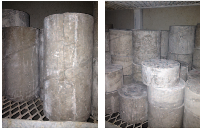
Figure 2-2 : Éprouvettes \Phi 11H22 cm de béton APPLET stockées en salle humide au LaSIE depuis 2007
