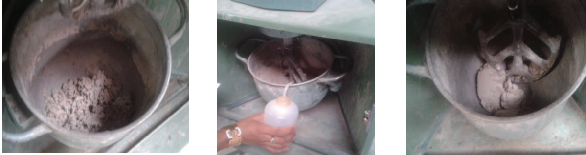
Figure 2-11 : Illustration de l'essai de demande en eau proposé par T. Sedran [183]
