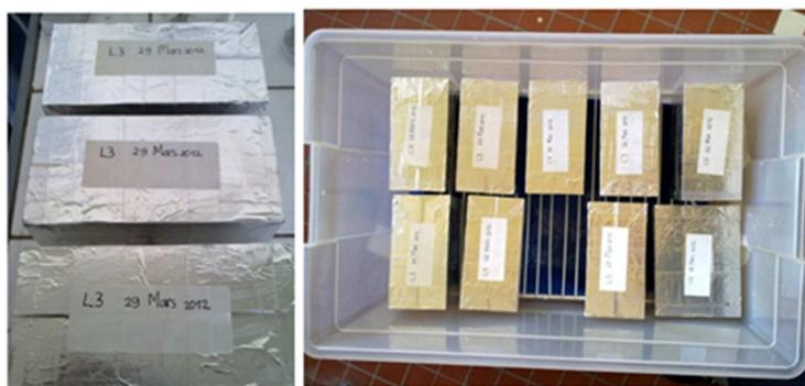
FIG. 2.3 – *Eprouvettes conservées en conditions endogènes*
