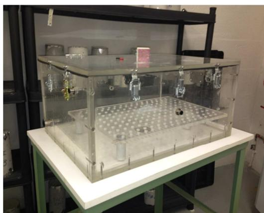
FIG. 5.2 – Enceinte de carbonatation accélérée
