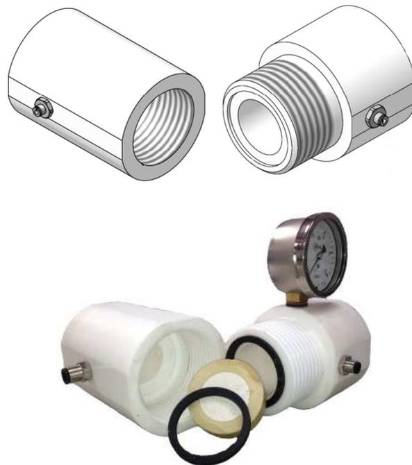
FIG 4.2 – *Eléments composant la cellule de diffusion ; en haut schémas des compartiments aval (à droite) et amont (à gauche) ; en bas une vue avec les bagues d'étanchéité et un échantillon.*
