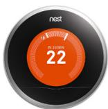
*Thermostat Nest* : Le thermostat Nest embarque des capteurs de température, d'humidité, de présence et de luminosité ambiante. Connecté à internet par Wi-Fi (mais alimenté par le secteur), il peut également communiquer avec d'autres équipements compatibles (détecteur de fumée, de CO<sub>2</sub>, fil pilote de chaudière) via les protocoles 802.15.4 et Bluetooth Low
