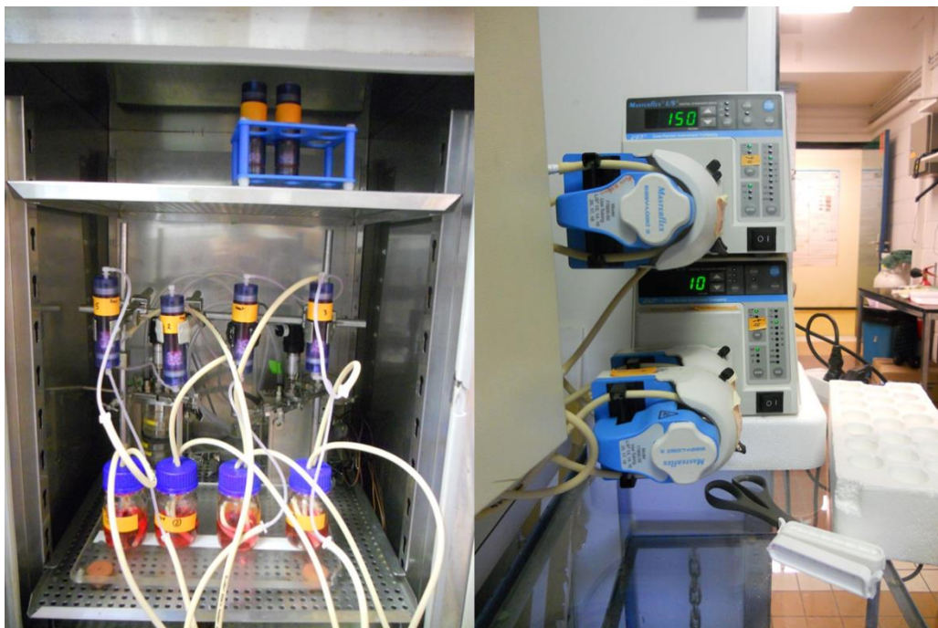
Figure IV-3 : Bioréacteurs pendant une expérience de flux, avec les pompes péristaltiques, le système de tubulure et le réservoir de milieu de culture.
