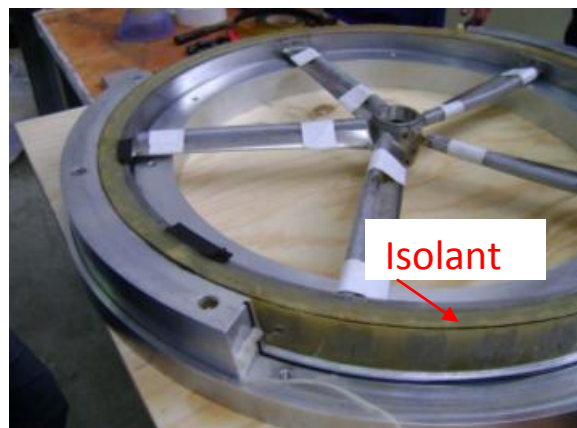
Figure. II.11. rotor d'une hydrolienne Rim-Driven avec entrefer immergé dans l'eau (parties actives isolées par un isolant polymère), IRENav [Dro01].
