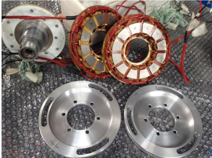
Figure. V.11. vue globale sur les stators et les éléments constituant la carcasse (source ECA-EN).
