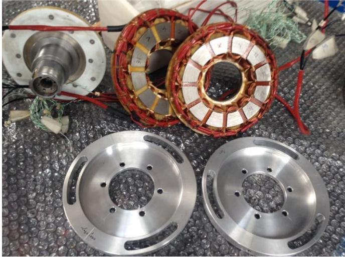
**Figure. V.11.** vue globale des stators et des éléments constituant la carcasse (source ECA-EN).
