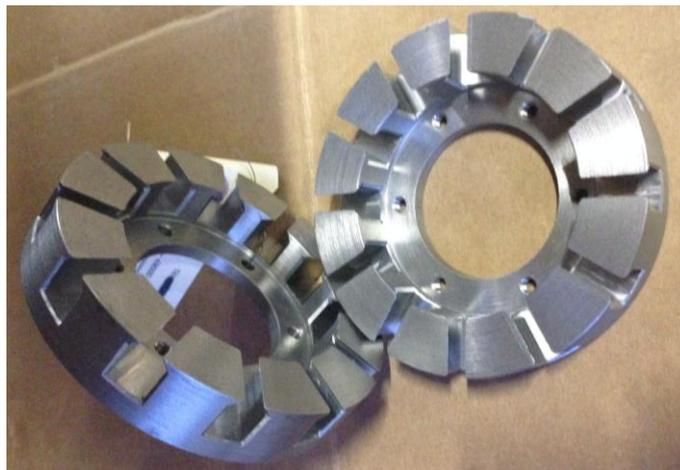
**Figure. V.9.** usinage des deux stators (source ECA-EN).
