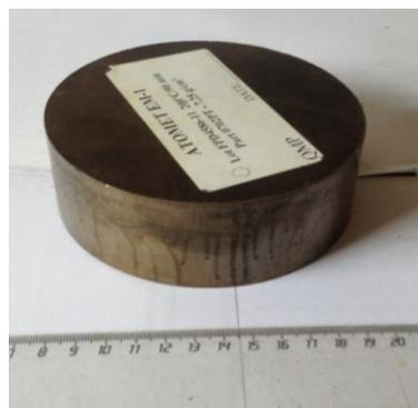
Figure. V.1. vue de l'une des éprouvettes SMC dont dispose l'IRENav (la règle située sur la vue est graduée en cm)
