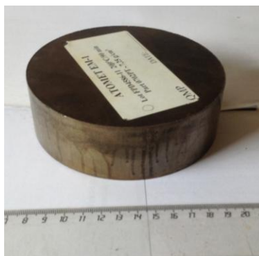
Figure. V.1. vue sur l'une des éprouvettes SMC dont dispose l'IRENav (la règle située sur la vue est graduée en cm)
