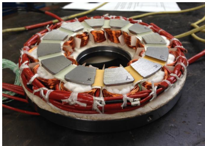
Figure. V.10. bobinage du stator (Source ECA-EN).
