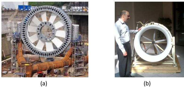
Figure. I.10. (a) vue sur le rotor de l'hydrolienne OpenHydro 500kW, (b) démonstrateur d'hydrolienne Rim-Driven IRENav [Dro01].
