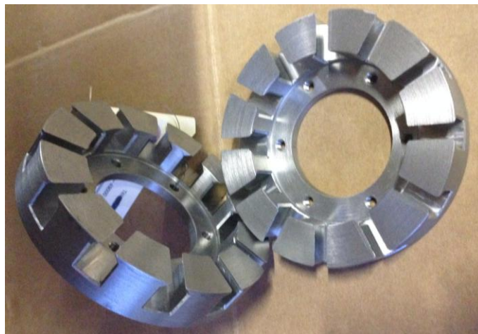
Figure. V.9. usinage des deux stators (source ECA-EN).
