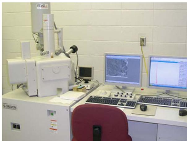
Figure II.9 : Microscope électronique à balayage (MEB).
