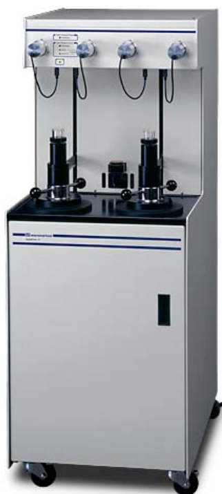
Figure II.8 : appareil de mesure de porosité par intrusion de mercure
