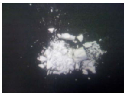
Figure IV.2 : effondrement d'un monolithe de faible résistance mécanique.
