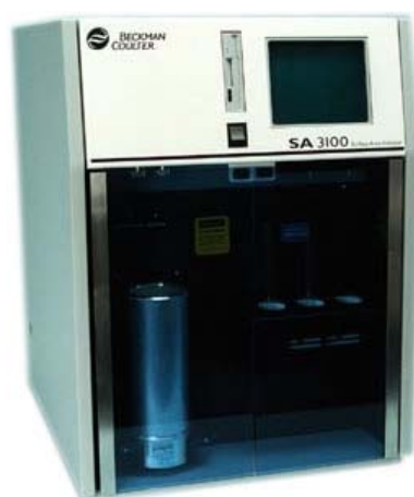
Figure II.7 : appareil de mesure de surface spécifique et porosité des matériaux par adsorption/désorption d'azote
