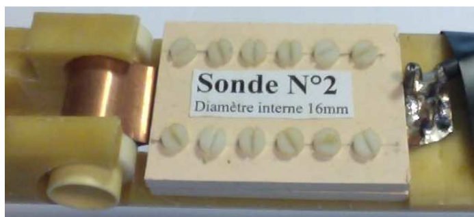
Figure 46 : Antenne RF « Loop gap resonator » de diamètre 16 mm. Cette antenne a l'avantage de fournir un champ RF intense et homogène.
