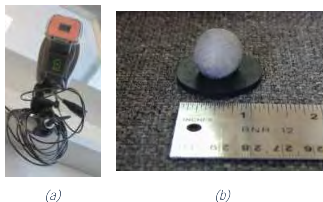
Figure 13 Gros plan sur une caméra infrarouge et le réseau de LEDs de la Motion Capture (a), et d'un marqueur (b).
