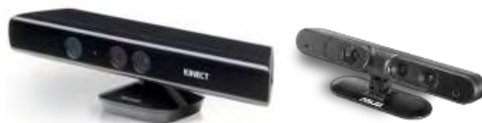
Figure 2 Capteurs de profondeur à lumière structurée.
