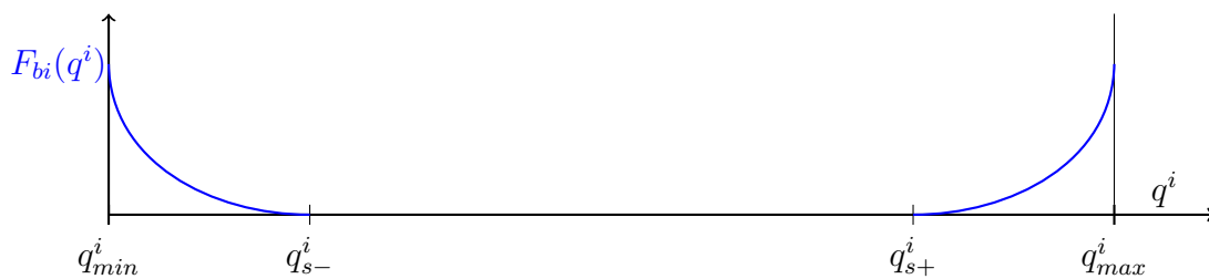
FIGURE 4.11 – Fonction répulsive en dehors de l'intervalle de sécurité. Elle tend vers +\infty quand q^i tend vers q_{min}^i ou q_{max}^i .
