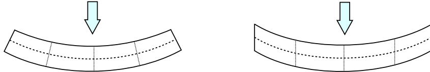
FIGURE 1.10 – Tige de Kirchhoff ne considérant pas le cisaillement du fait de l'hypothèse d'orthogonalité des sections à la fibre neutre (à gauche) et tige de Timoshenko avec prise en compte du cisaillement (à droite).
