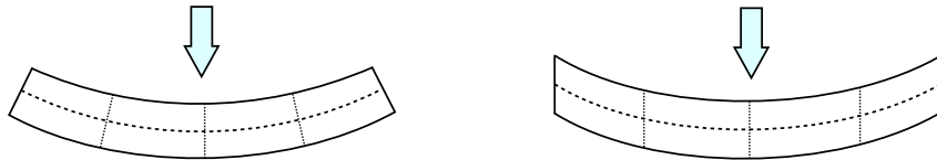
FIGURE 1.10 – Tige de Kirchhoff ne considérant pas le cisaillement du fait de l'hypothèse d'orthogonalité des sections à la fibre neutre (à gauche) et tige de Timoshenko avec prise en compte du cisaillement (à droite).
