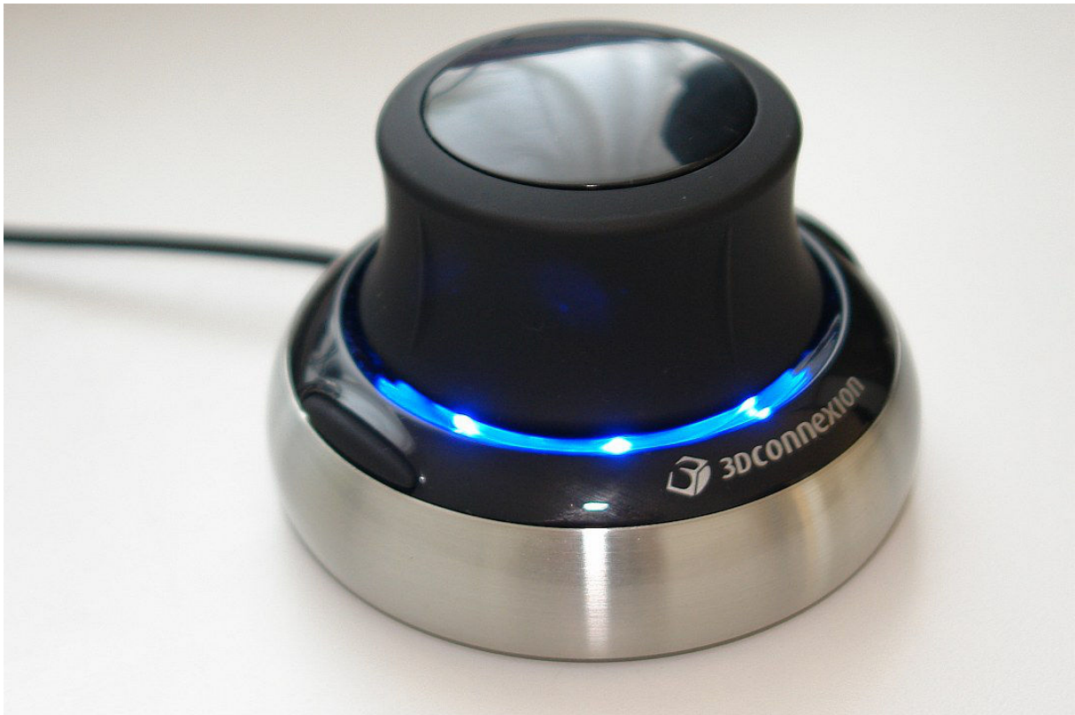
FIGURE 3.3 – SpaceNavigator de 3DConnexion. Ce dispositif mesure 3 composantes d'efforts en translations et 3 composantes d'efforts en rotation qui permettent le contrôle de la position et de l'attitude d'un objet dans un environnement 3D.
