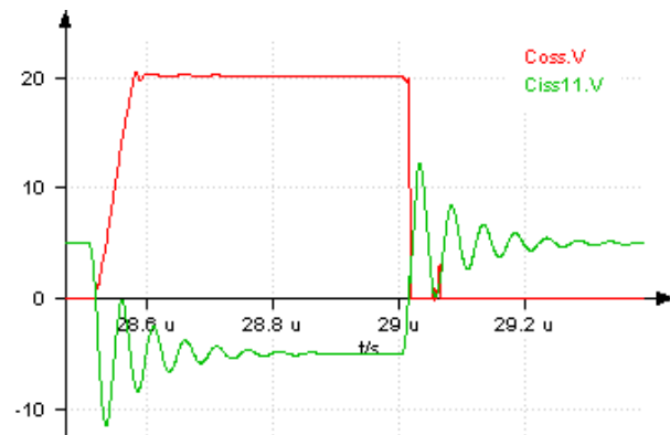
Figure 168 : Simulation du montage Buck avec une tension d'entrée de 20V et un courant d'entrée de 0.21A.
