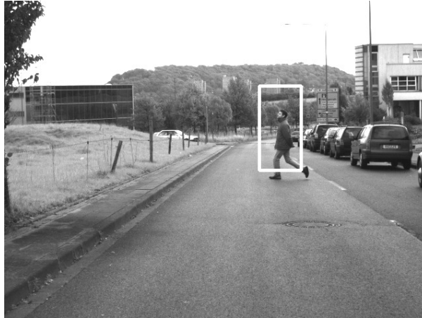
Fig. 4.28: Exemple de détection de l'implémentation matérielle générée par CAPH sur la base Daimler [EG09]
