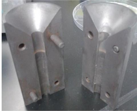
**Figure V-37 : Moule cylindrique utilisé pour la formation des préformes**
