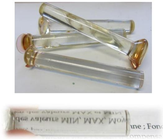
**Figure V-38 : Barreaux de verres des systèmes GGN et GGNB**
