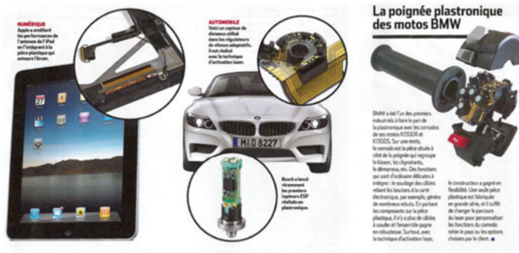
Figure 6 – Exemples de dispositifs plastroniques intégrés dans des systèmes industriels (a) antenne pour tablette tactile de la société Apple, (b) capteur de distance de la société Harting, (c) capteur de pression DS8 de la société Bosch, (d).comodo de moto [17]
