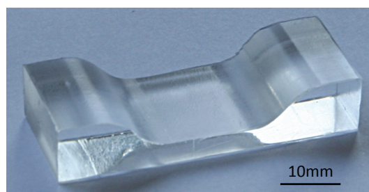
Figure 78 – Substrat 3D V1 en COC obtenu par hot embossing
