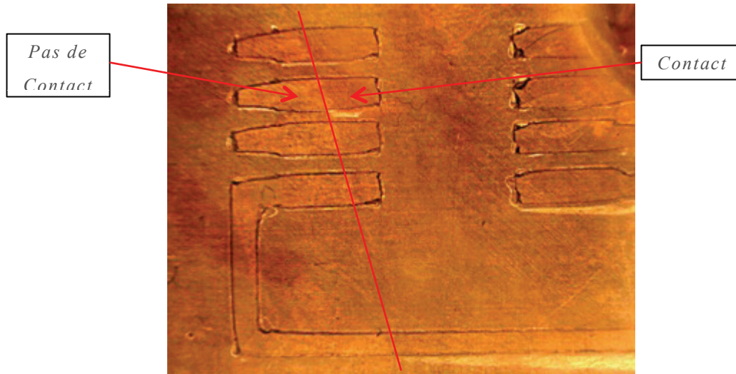
Figure 35 – Visualisation du contact par la caméra
