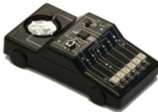
Figure 64 – Démonstrateur réalisé par structuration laser, fourni lors de la conférence 3D MID
