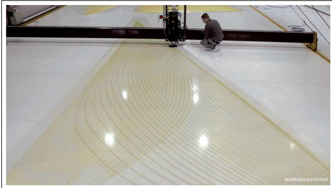
Fig. 1.7 – Production d'une voile en toile laminée à fibres orientées [69].
