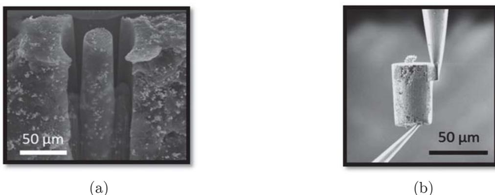
FIGURE 2.15 – Images MEB de préparation FIB d’une électrode de batterie [99].
