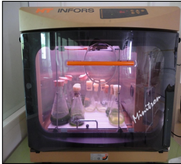
Figure 18. Incubateur «Minitron» de culture de C. vulgaris
