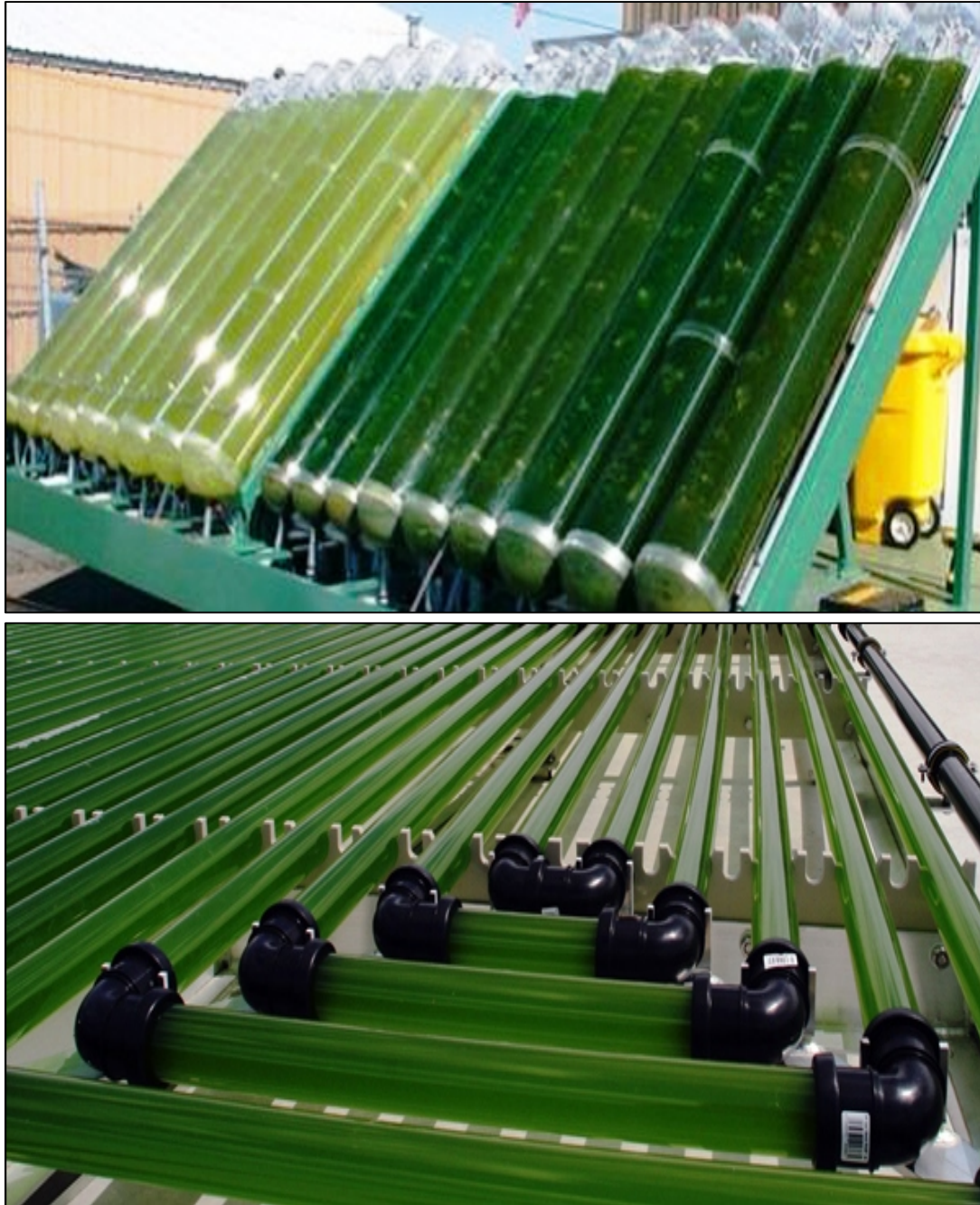
Figure 14. Différentes configurations des bioréacteurs des microalgues
