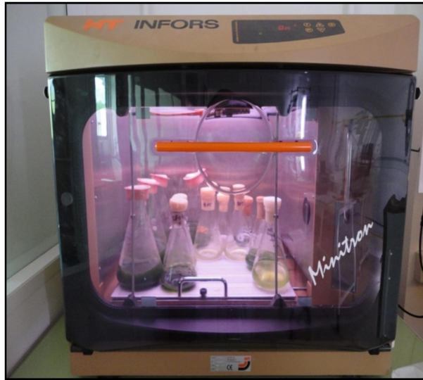
Figure 18. Incubateur «Minitron» de culture de C. vulgaris
