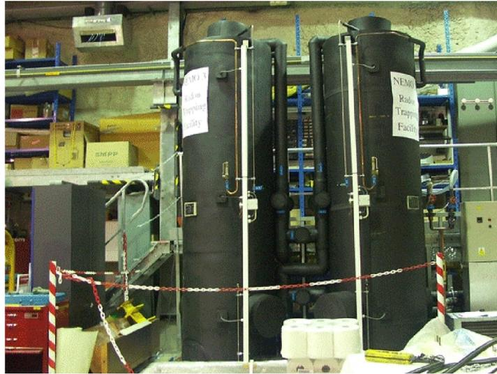
FIGURE 3.8: Photographie de deux colonnes de charbon actif. Seule l'une d'entre elles a été utilisée durant la phase 2 de la prise de données du détecteur NEMO3.
