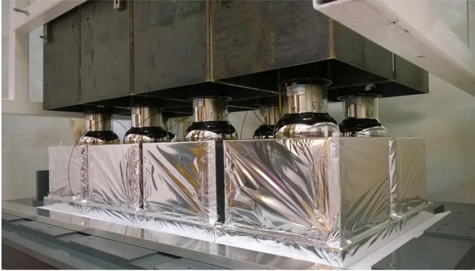
FIGURE 2.15: Photographie représentant l'assemblage d'une brique  $2 \times 4$  du calorimètre : le blindage magnétique recouvre les compteurs calorimétriques associés PM 5'' et scintillateurs habillés de téflon et mylar aluminisé.
