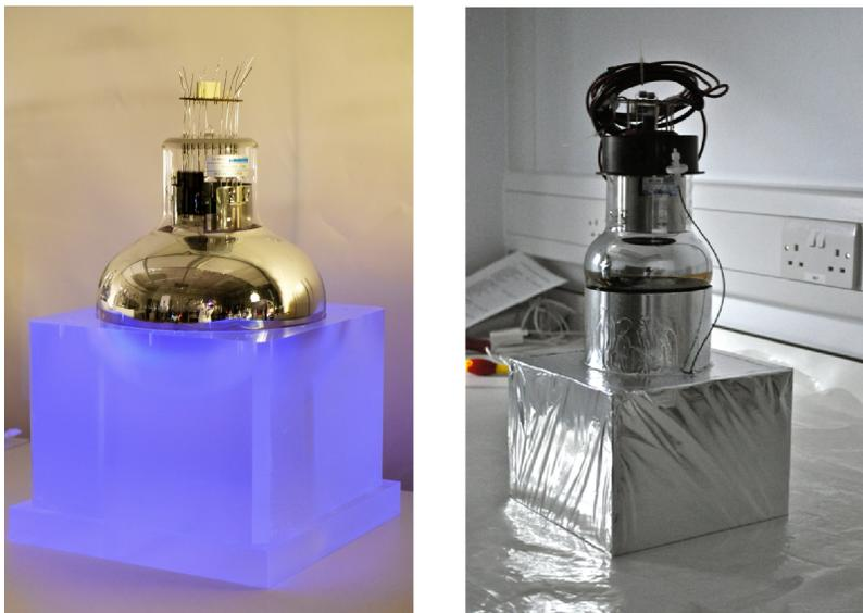
FIGURE 2.14: Photographies représentant deux compteurs calorimétriques de SuperNEMO associant un PM 8" à un scintillateur creusé non habillé pour les murs principaux du calorimètre (à gauche) et un PM 5" à un scintillateur habillé par l'intermédiaire d'un guide optique pour les murs latéraux (à droite) .
