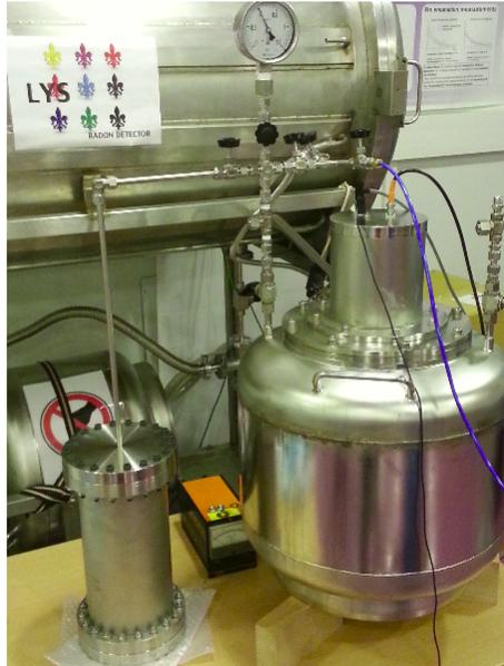
FIGURE 4.12: Photographie de la petite chambre d'émanation (à gauche) associée à un manomètre (en haut) et au détecteur de Radon 2 (à droite).
