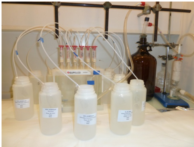
Figure 2.18. Etape de chargement des échantillons d'eau sur les cartouches Strata X-AW.
