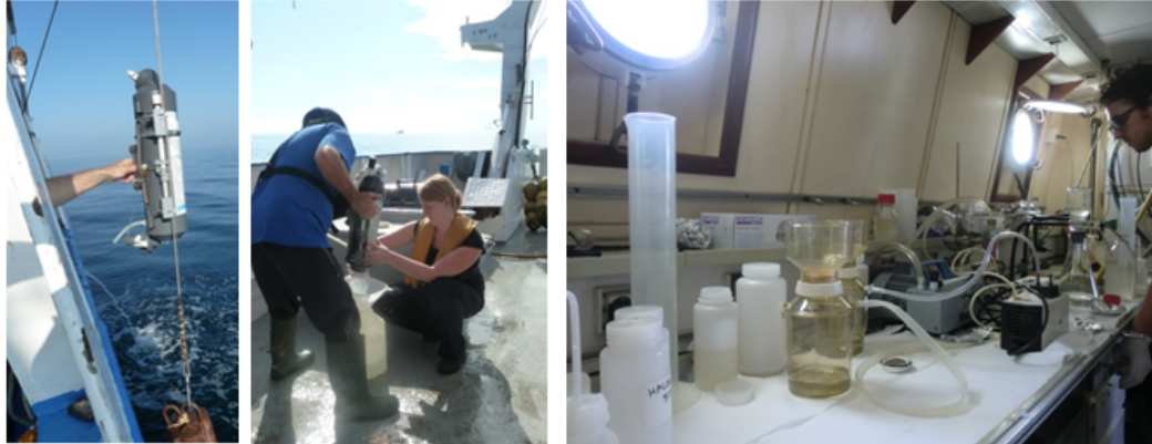
Figure 2.11. Prélèvement d'eau à l'aide d'une bouteille Niskin et filtration à bord (HALOGIR).
