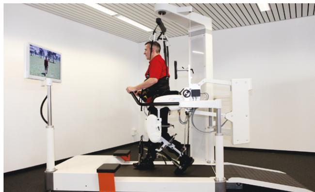
FIGURE 1.25 – Lokomat by Hocoma, permettant la rééducation des membres inférieurs tout en supportant une partie du poids de son utilisateur si nécessaire
