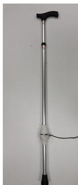
FIGURE 2.3 – Canne instrumentée à l'aide d'un capteur 6 axes
