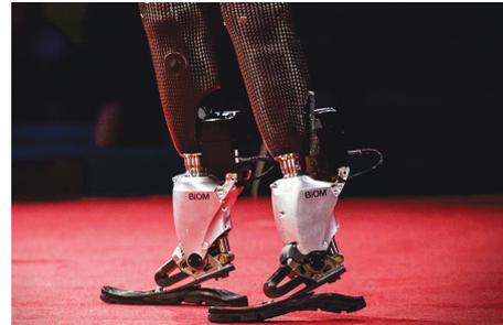
FIGURE 1.23 – Prothèse robotisée développée par BiOM
