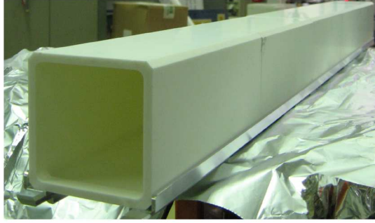
FIGURE 40 – Volume de conversion, composé de 5 parallélépipèdes de BeO de 20 cm de long chacun. Le volume est fermé par deux plaques de Be à ses extrémités.
