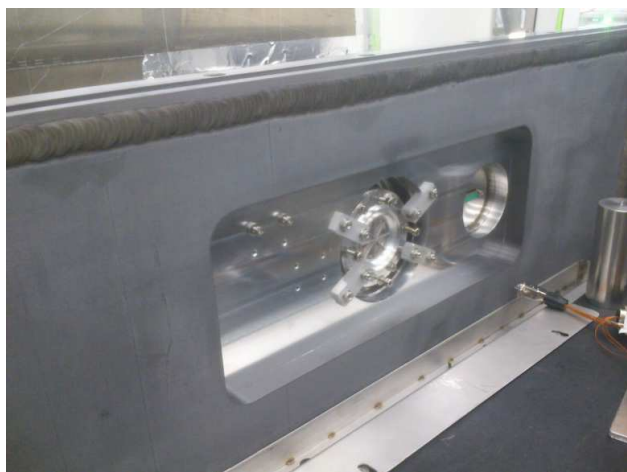
FIGURE 56 – Arrivée des UCN dans le spectromètre.
