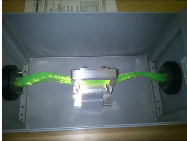
FIGURE 84 – Prototype du réseau de fibres optiques.
