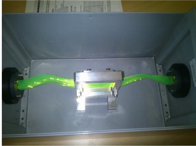
FIGURE 84 – Prototype du réseau de fibres optiques.
