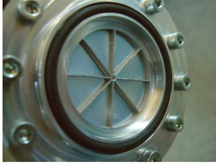
FIGURE 41 – Fenêtre d'extraction, renforcée par 8 ailettes en aluminium de chaque côté pour la résistance mécanique. Ainsi, une feuille de 30  $\mu\text{m}$  d'aluminium peut résister à une différence de pression de 3 bar.
