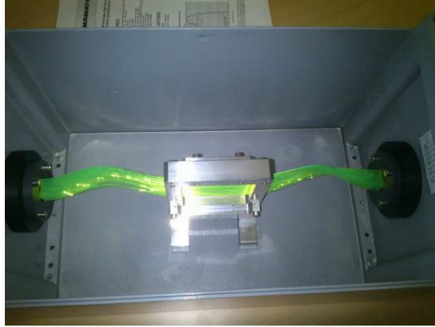
FIGURE 84 – Prototype du réseau de fibres optiques.
