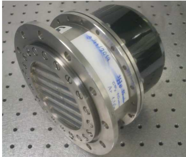
FIGURE 43 – Détecteur gazeux utilisé pour le comptage des UCN en sortie de l'extraction. La chambre proportionnelle est remplie à 15 mbar de ^3\text{He} , 10 mbar de \text{CO}_2 et 1.1 bar de Ar. Selon la mesure, la fenêtre du détecteur est en aluminium ou en titane.
