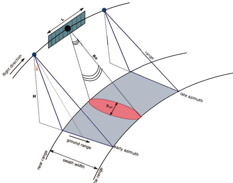
FIGURE 2.10: Schéma de la géométrie d'acquisition d'une antenne SAR.
