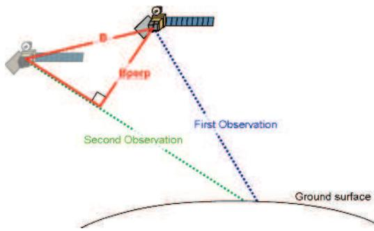
FIGURE 2.11: Schéma représentant la différence de point de vue entre deux acquisitions du satellite. Les deux positions sont séparées par une ligne de base,  $B$ .  $B_p$  représente composante perpendiculaire de cette ligne de base. On montre que la contribution topographique et la contribution due aux erreurs de MNT sont proportionnelles à  $B_p$ .
