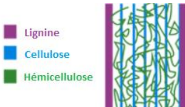
Figure I-2 : Représentation schématique d'une fibrille de lignocellulose. 2
