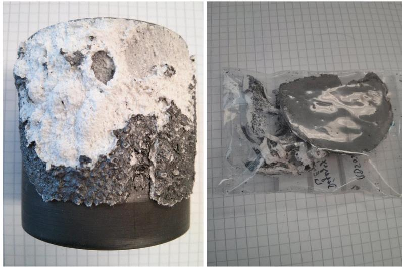
**Figure 77 : Résultat après expérimentation en diamètre 60 mm (piston à gauche et matière éjectée à droite)**
