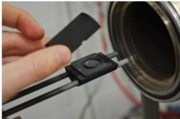
**Figure 24 : Suscepteur en carbone du four à induction**
