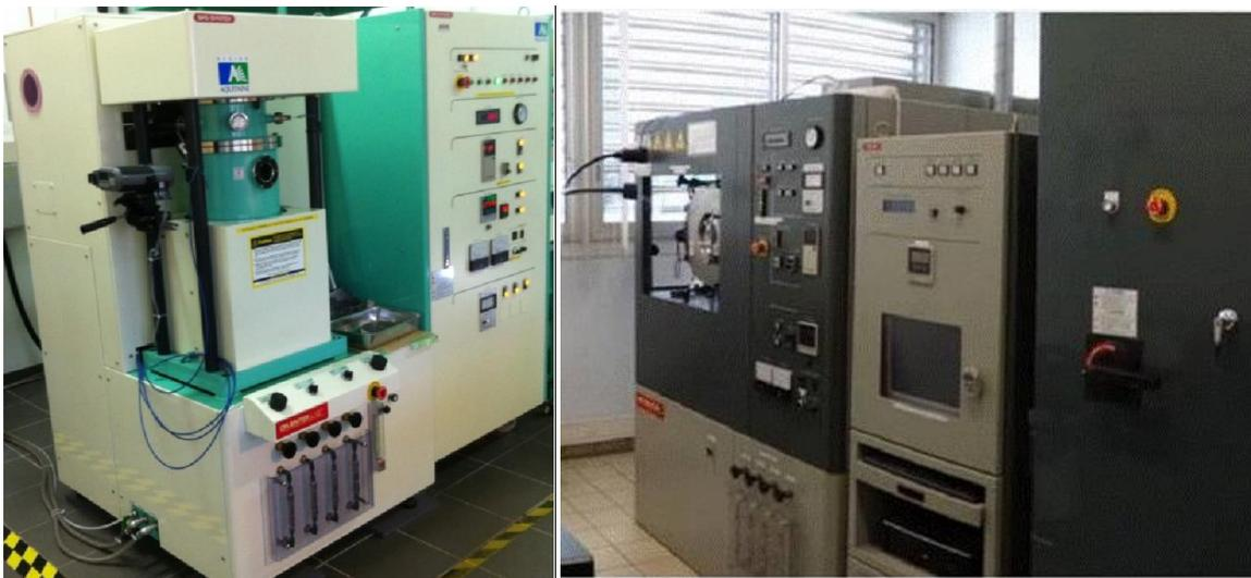
**Figure 18 : Installation de SPS à l'ICMCB (gauche) et au CIRIMAT (droite)**
