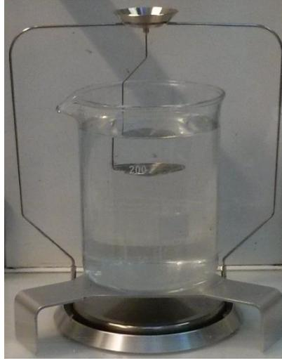
Figure 25 : Montage pour pesée hydrostatique
