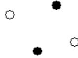
FIG. 2.5 – Un exemple de l'impossibilité de pulvériser 4 points dans \mathbb{R}^2 à partir d'un espace d'hypothèses \mathcal{H}_2^{\text{hyperplan}} .
