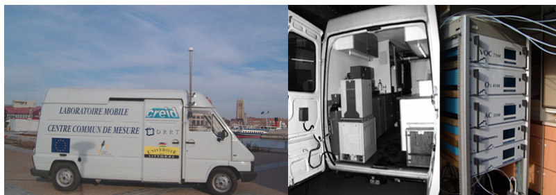
Figure III-8 : Unité mobile du CCM-ULCO dédiée à la surveillance des NO_x , NO , NO_2 , O_3 , SO_2 , CO .
