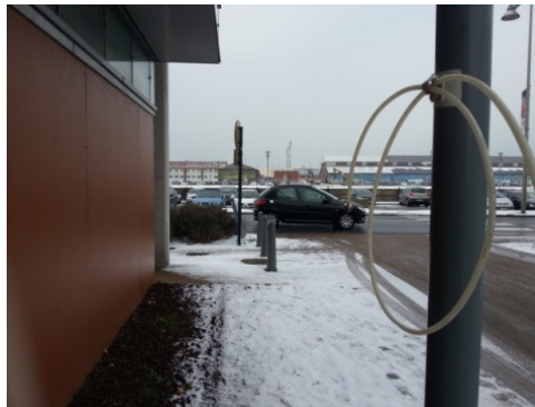
Figure III-7 : Tube en Téflon utilisé pour l'échantillonnage et fixé à 1,8 m du sol.
