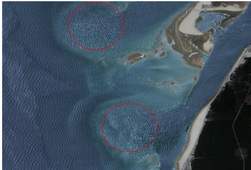
Figure 6.2. Exemple de l'impact du sun glint sur l'imagerie satellite très haute résolution (Sources : CNES/RTU-PLÉIADESS)
