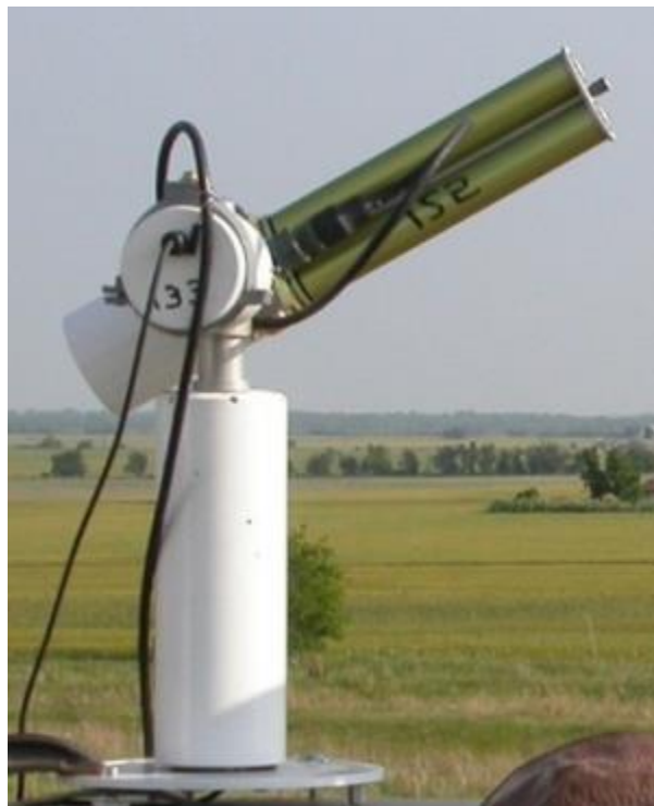
Figure 4.5. CIMEL CE318, utilisé par la plupart des sites AERONET (Sources : CIMEL)
