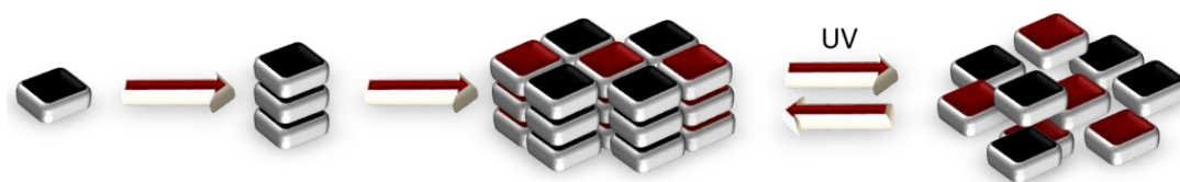
Figure III-21 : Schéma présentant le contrôle de la formation d'une mésophase par un stimulus UV.
