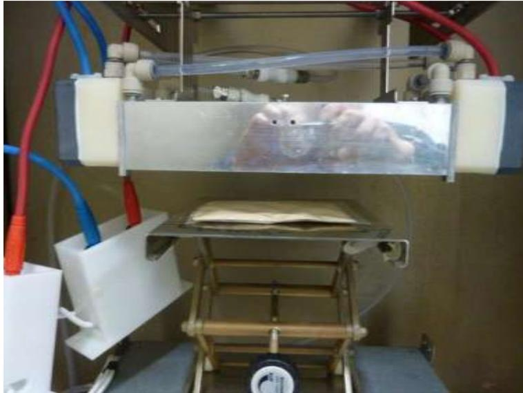
Figure 25 : dispositif de lumière pulsée
