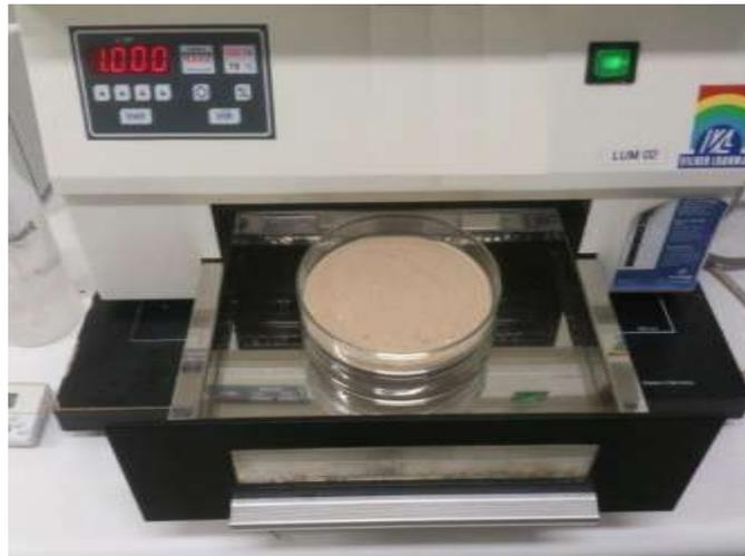
Figure 24 : appareil utilisé pour l'irradiation de la rafle par un rayonnement UV
