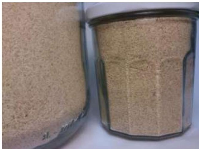
Figure 121 : à gauche, Poudre 2 non traitée, à droite, Poudre 2 traitée par autoclave
