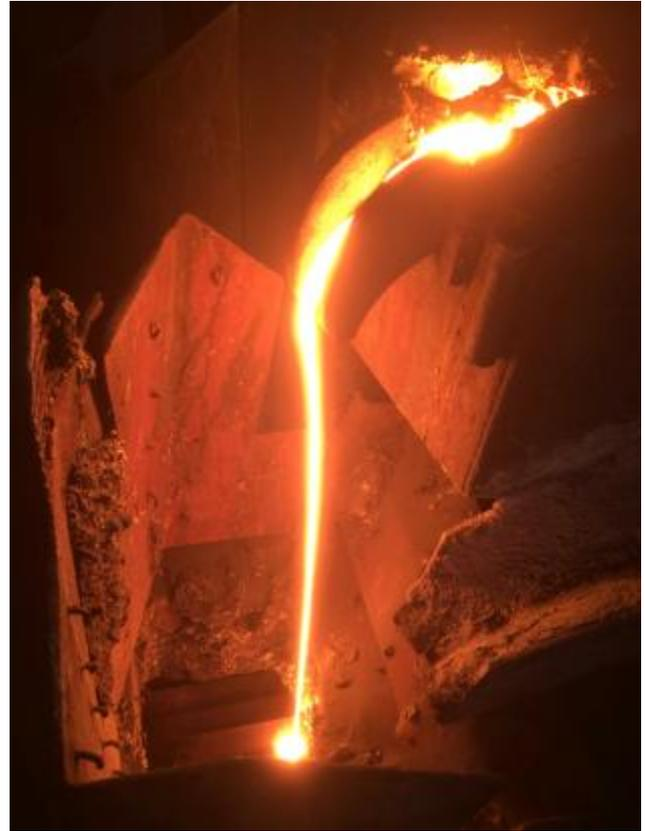
Figure 63 : Photographie de la sortie de laitier.
