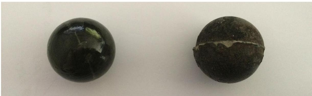
*Figure 80 : Conception de sphères de 4 cm (vitreuse à gauche et cristallisée à droite).*
