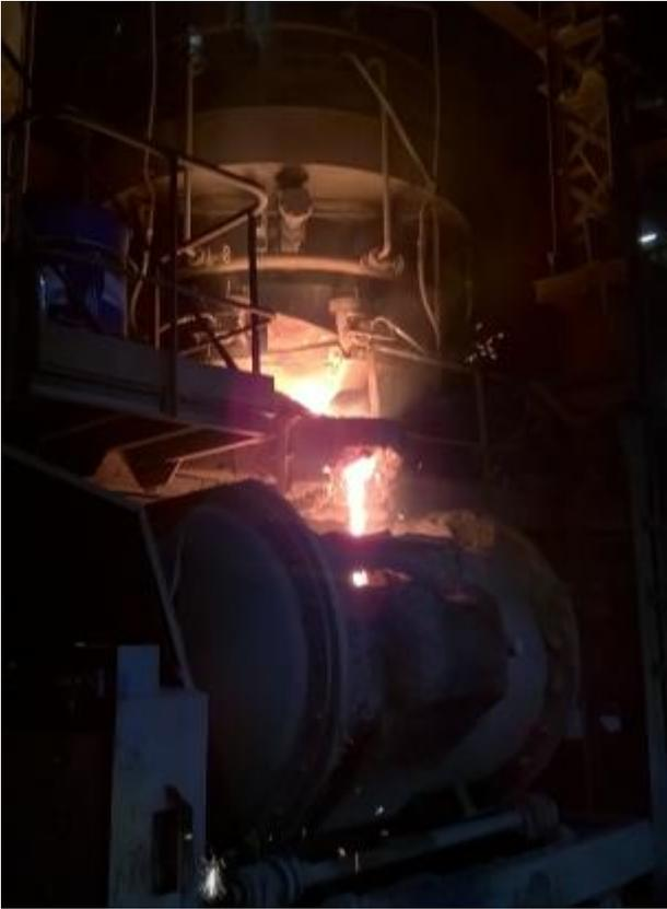
Figure 62 : Photographie de la sortie de la fonte.
