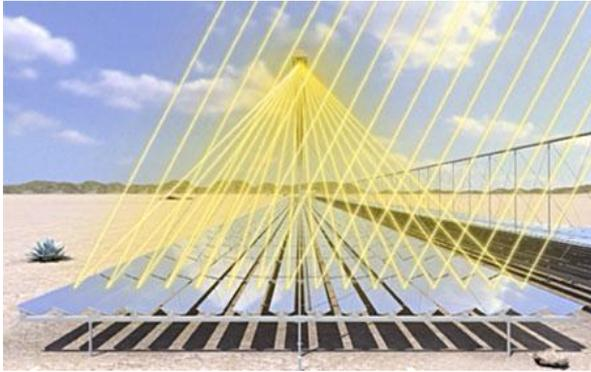
Figure 5 : Schéma de principe d'un linéaire Fresnel.
