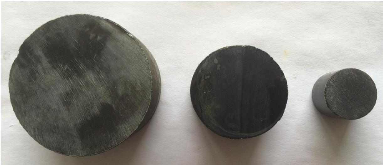
*Figure 79 : Conception de cylindres en laitier de 7,5 cm, 5cm et 3 cm.*
