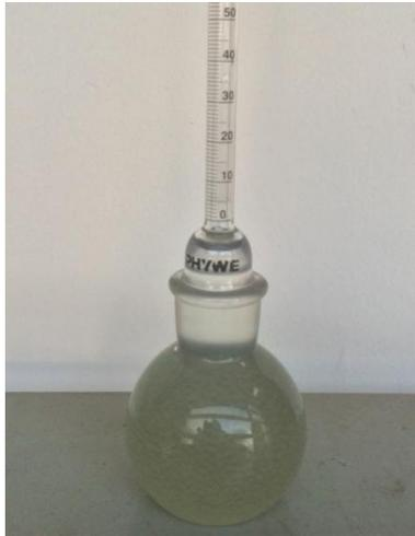
Figure 53 : Pycnomètre.
