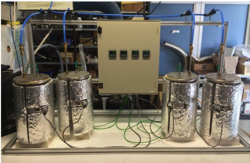
Figure 83 : Banc de comptabilité avec le coffret électrique et les quatre réacteurs.
