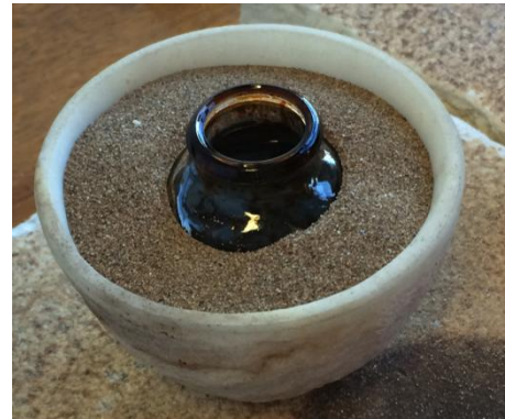
Figure 43 : Creuset en céramique avec le flacon d'huile et le sable de quartz.
