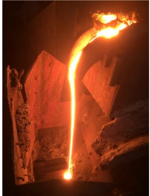
Figure 63 : Photographie de la sortie de laitier.
