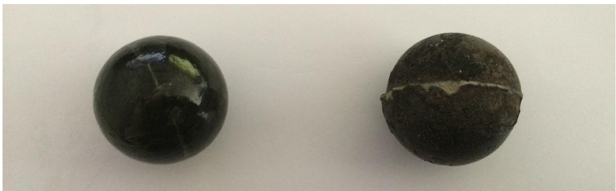
Figure 80 : Conception de sphères de 4 cm (vitreuse à gauche et cristallisée à droite).
