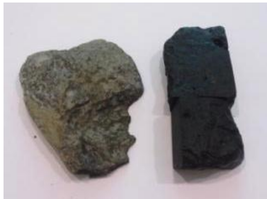
Laitier de haut fourneau après 2160 heures d'imprégnation
