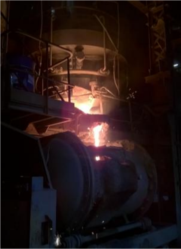
Figure 62 : Photographie de la sortie de la fonte.
