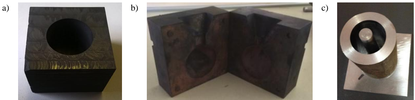
Figure 65 : Moules : a) cylindre en graphite, b) sphère en fonte GS et c) anneau de Raschig en acier E24.
