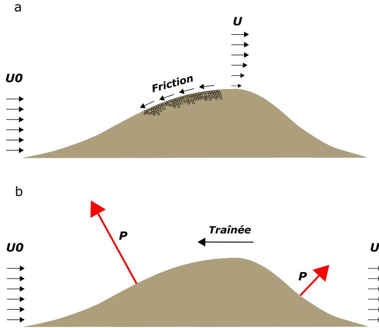
FIGURE 1.5 – Résistance à l'écoulement au dessus des formes de fond. Frottement de paroi (a) et forces normales de pression (b).  $U_0$  et  $U$  sont respectivement la vitesse moyenne initiale et locale de l'écoulement.  $P$  symbolise les forces de pression.
