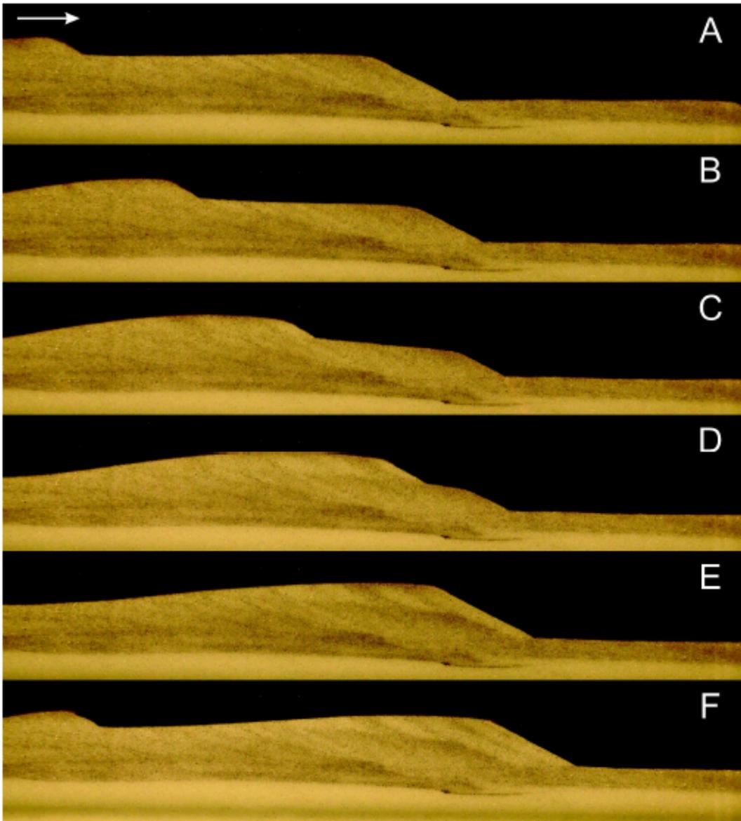
FIGURE 2.8 – Séquence d'appariement entre deux rides visualisée à travers les parois d'un canal bidimensionnel d'épaisseur 5 mm. L'intervalle de temps est de  $\Delta t = 20$  s entre chaque image. Figure de *Best et al.* (2013).
