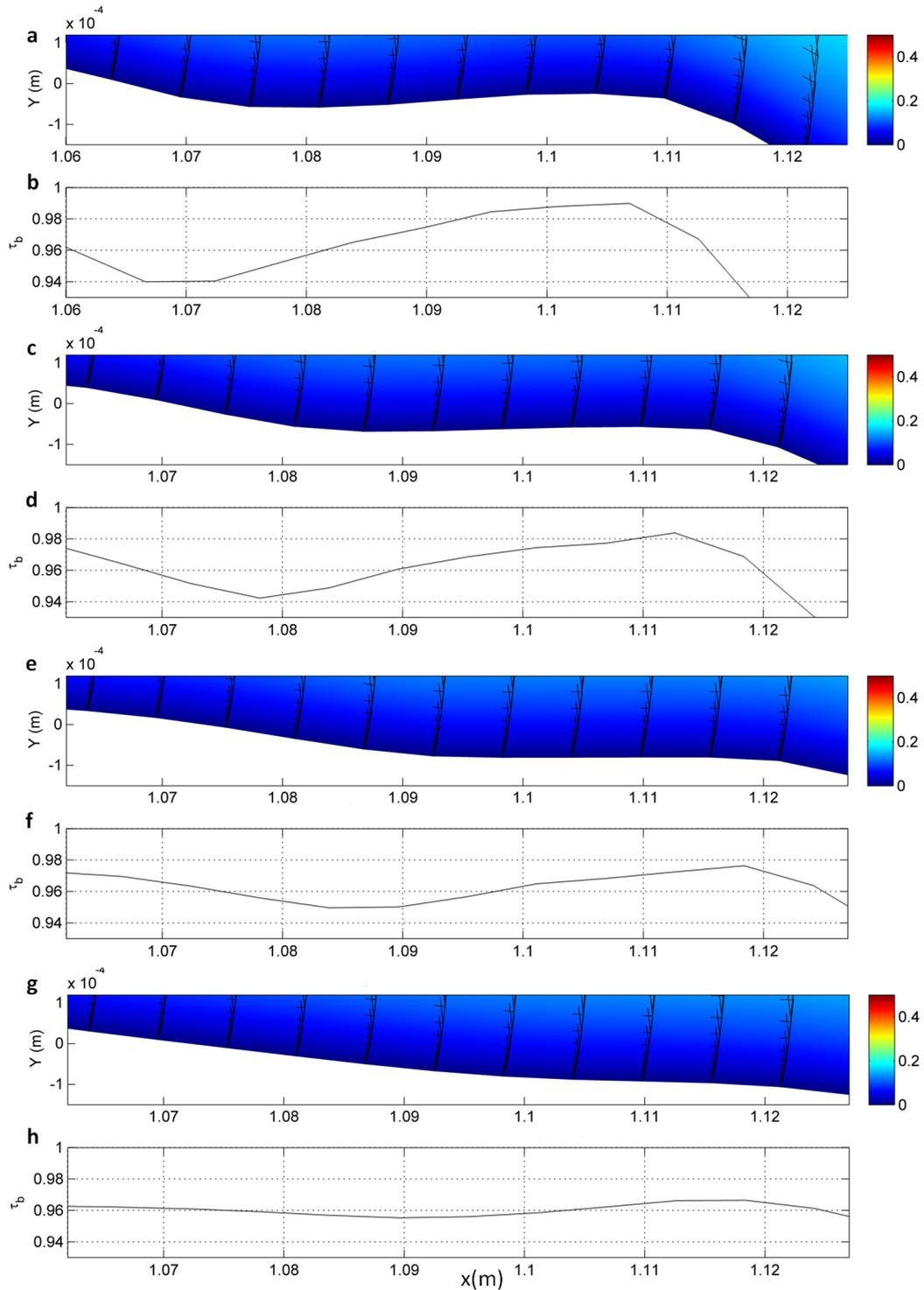
FIGURE 4.18 – Focus sur l'évolution d'une perturbation 'déclinante' entre  $t = 5$  s et  $t = 8$  s. Champs des vitesses horizontales à  $t = 5$  s,  $t = 6$  s,  $t = 7$  s, et  $t = 8$  s (a,c,e,g) et profil de la contrainte de cisaillement à  $t = 5$  s,  $t = 6$  s,  $t = 7$  s, et  $t = 8$  s (b,d,f,h).
