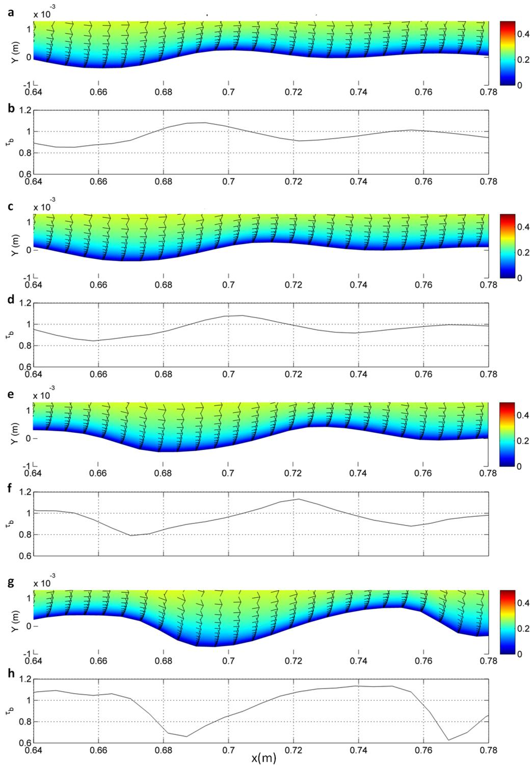
FIGURE 4.17 – Focus sur l'évolution d'une perturbation 'croissante' entre  $t = 8$  s et  $t = 15$  s. Champs des vitesses horizontales à  $t = 8$  s,  $t = 10$  s,  $t = 13$  s, et  $t = 15$  s (a,c,e,g) et profil de la contrainte de cisaillement à  $t = 8$  s,  $t = 10$  s,  $t = 13$  s, et  $t = 15$  s (b,d,f,h).
