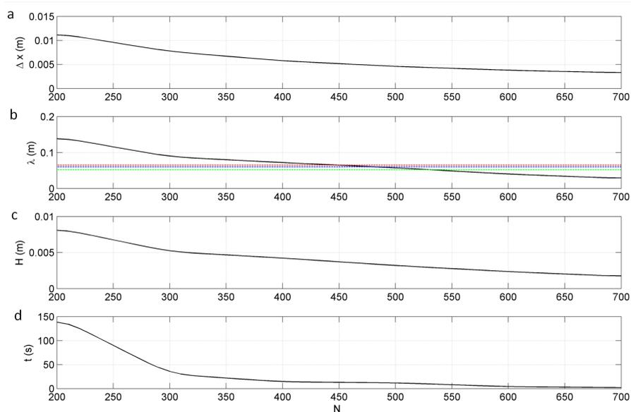
FIGURE C.4 – Résolution du maillage (a), longueur d’onde et hauteur simulées (b) et (c), et temps d’évolution du champ de rides (d) en fonction du nombre de mailles  $N_x$ , pour un grain de diamètre  $d_{50} = 0.2$  mm,  $\theta = 0.4$ . Les lignes pointillées bleue, rouge et verte représentent les longueurs d’ondes données par les modèles mathématiques de *Fourrière et al.* (2010), *Charru* (2006) et la relation de *Coleman et al.* (2003).
