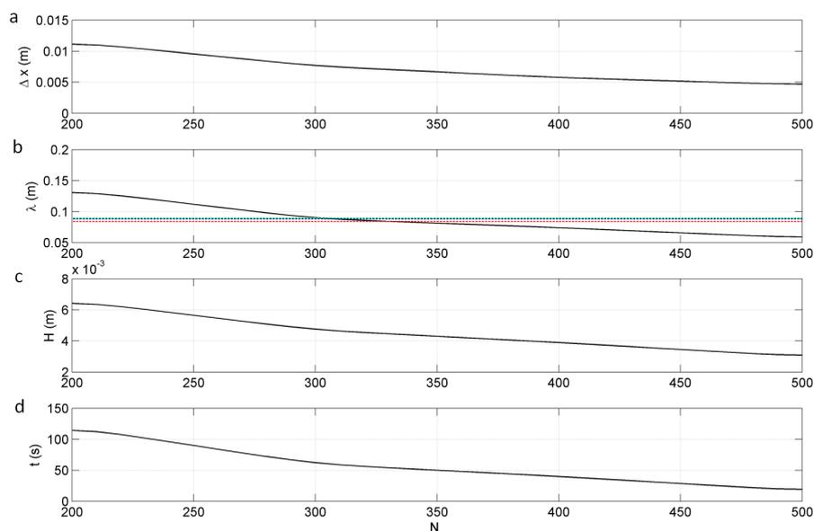
FIGURE C.5 – Résolution du maillage (a), longueur d’onde et hauteur simulées (b) et (c), et temps d’évolution du champ de rides (d) en fonction du nombre de mailles  $N_x$ , pour un grain de diamètre  $d_{50} = 0.4$  mm. Les lignes pointillées bleue, rouge et verte représentent les longueurs d’ondes données par les modèles mathématiques de *Fourrière et al.* (2010), *Charru* (2013) et la relation de *Coleman et al.* (2003).
