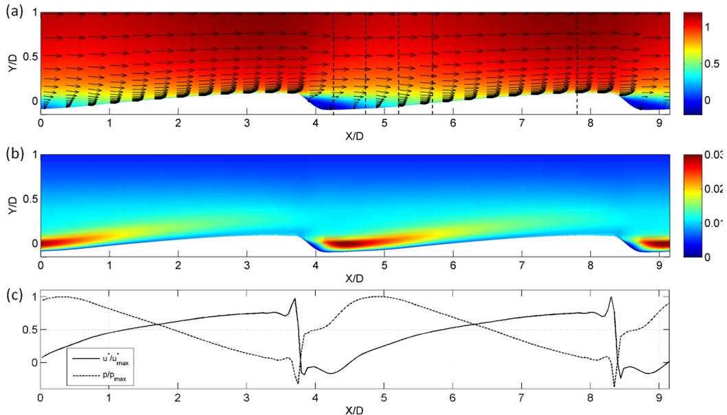
FIGURE 3.3 – Simulation de l’écoulement au-dessus d’un champ de dunes. Champ des vitesses horizontales,  $\frac{U_x}{U_0}$  (a), champ de l’énergie cinétique turbulente,  $\frac{k}{U_0^2}$  (b) et profils de la vitesse de cisaillement et de la pression au fond normalisées (c).  $k_N = 7.25 \cdot 10^{-4}$ ,  $U_0 = 0.64 \text{ m.s}^{-1}$ ,  $N_x = 200$ ,  $N_y = 40$ .
