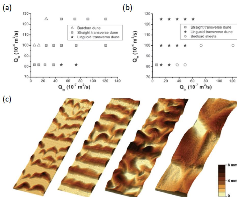
FIGURE 5.1 – Diagramme de phase des types de formes sableuses à l'équilibre en fonction du débit et de la quantité de sédiment injecté. (a) Cas avec  $d_{50} = 0.1$  mm, (b)  $d_{50} = 0.5$  mm, et (c) morphologie des formes de fond à l'équilibre, respectivement de gauche à droite : dunes barkhanes, dunes transverses rectilignes, dunes transverses linguoïdes et plaquages sableux. Image de *Dreano et al.* (2010)
