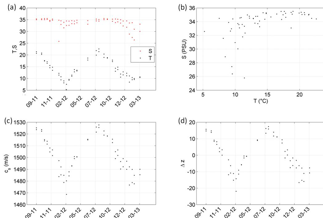
FIGURE D.2 – Courbes de l'évolution temporelle de la salinité  $S$  et de la température  $T$  (a), de la variation croisée de  $T$  et  $S$  (b), de la vitesse du son (c) et de l'écart de profondeur en centimètres induit par les variations de la vitesse pour une profondeur de 10 mètres (d), à la bouée 13 du chenal du bassin d'Arcachon entre Septembre 2011 et Mars 2013.
