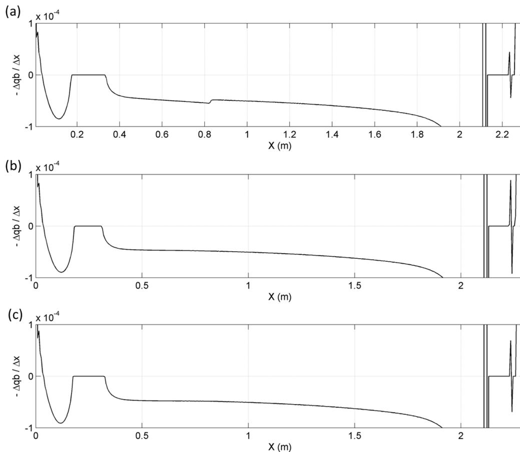
FIGURE 3.10 – Gradients de flux sédimentaires par charriage  $\frac{\Delta q_b}{\Delta x}$  au-dessus d'un profil triangulaire idéalisé pour la version actuelle de Dune2D (a), avec la formulation de type *Menter et Esch* (2001) (b) et avec la nouvelle version de Dune2D (c).
