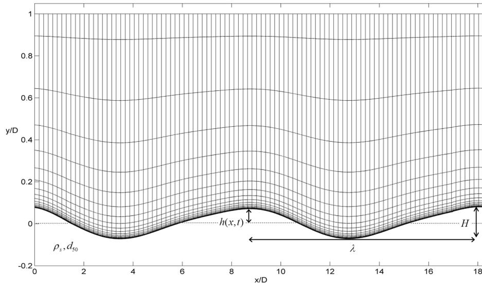
FIGURE 3.1 – Exemple de grille de calcul utilisée au-dessus de deux dunes (800 x 40). Une cellule sur quatre est représentée dans la direction de l'abscisse horizontale  $x$ .
