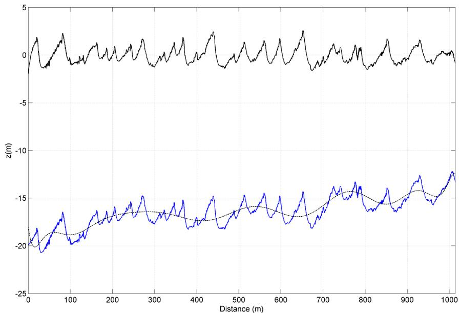
FIGURE 6.9 – Courbes de la profondeur du transect (bleu), de la régression polynomiale (courbe pointillée) et du transect résultant (noir).
