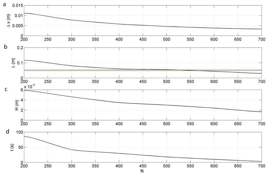
FIGURE C.3 – Résolution du maillage (a), longueur d’onde et hauteur simulées (b) et (c), et temps d’évolution du champ de rides (d) en fonction du nombre de mailles  $N_x$ , pour un grain de diamètre  $d_{50} = 0.2$  mm,  $\theta = 0.3$ . Les lignes pointillées bleue, rouge et verte représentent les longueurs d’ondes données par les modèles mathématiques de *Fourrière et al.* (2010), *Charru* (2006) et la relation de *Coleman et al.* (2003).
