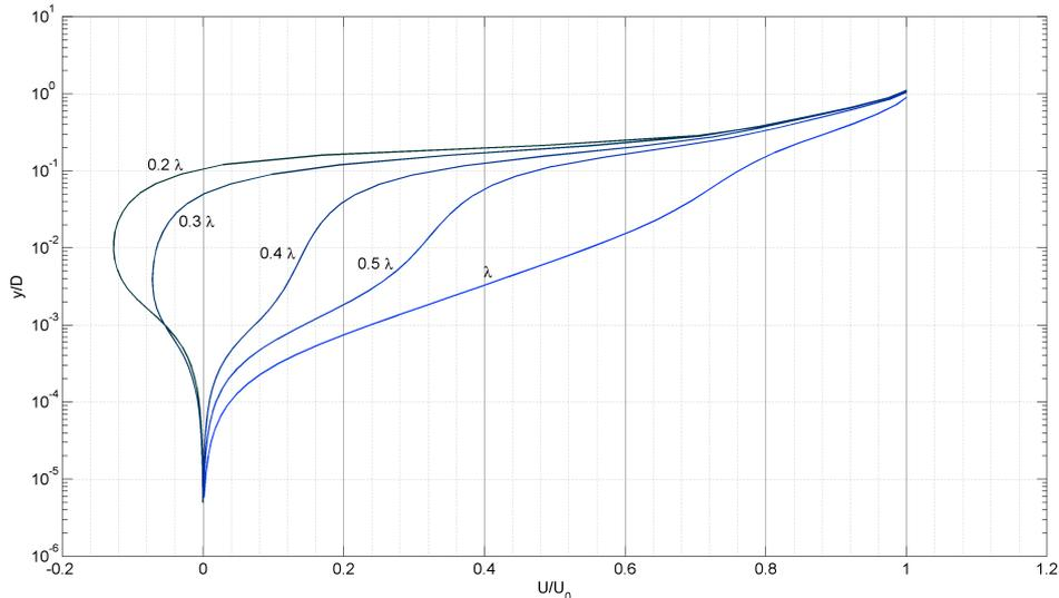
FIGURE 3.4 – Profils verticaux des vitesses adimensionnées en différents points du profil de la dune à une distance de  $0.2\lambda$ ,  $0.3\lambda$ ,  $0.4\lambda$ ,  $0.5\lambda$  et  $\lambda$  en aval de la crête. La position des profils est indiquée par des lignes pointillées sur la figure 3.3.
