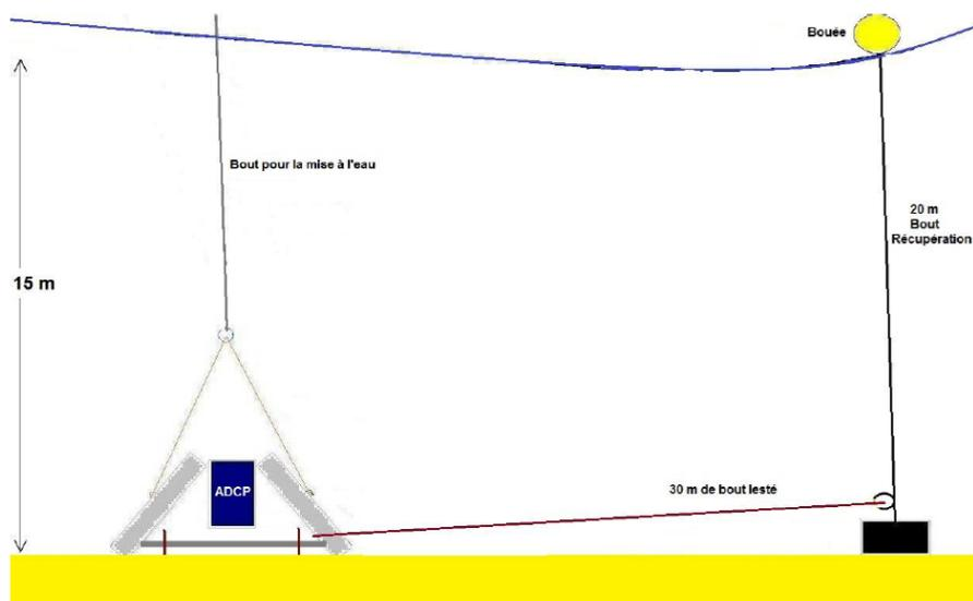
FIGURE D.8 – Schéma descriptif de l'arrimage de la structure de l'ADCP.
