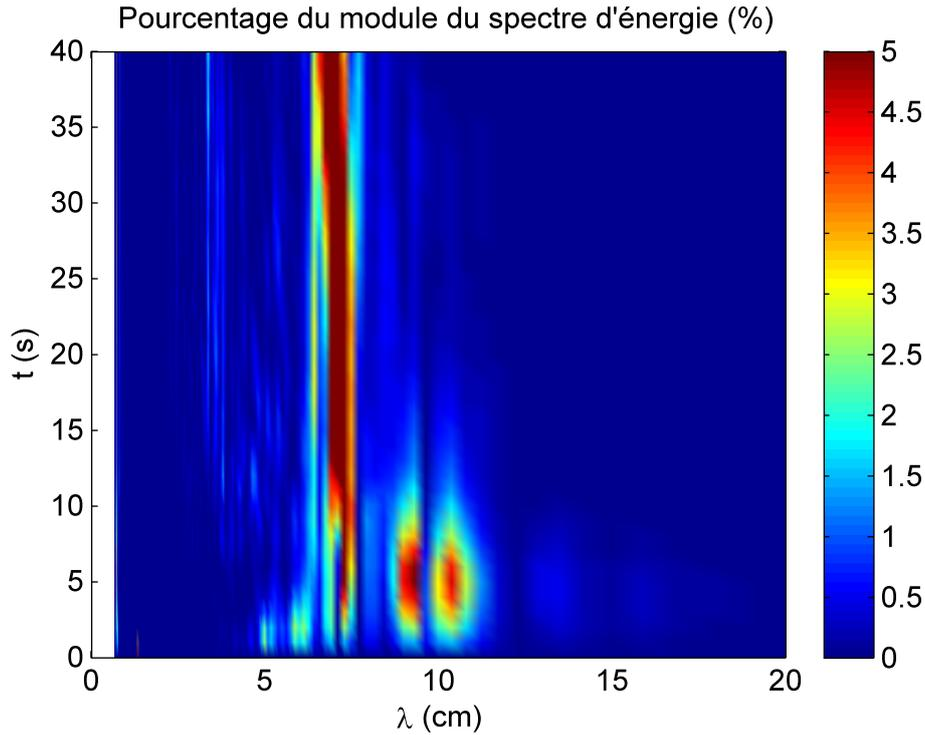
FIGURE 4.20 – Évolution du spectre d'énergie du fond faiblement perturbé dans les premiers instants de l'évolution.
