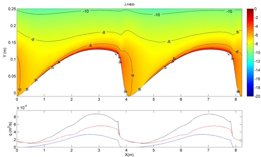
FIGURE C.13 – Champ de concentration de sédiment en suspension  $\ln c$  (haut), et profils de transport par charriage, en suspension et de transport total (bas) pour une longueur d'onde  $\lambda = 4$  m.
