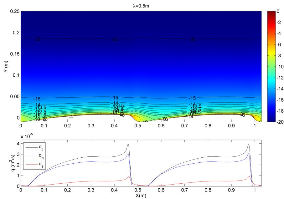
FIGURE C.11 – Champ de concentration de sédiment en suspension  $\ln c$  (haut), et profils de transport par charriage, en suspension et de transport total (bas) pour une longueur d'onde  $\lambda = 0.5$  m.
