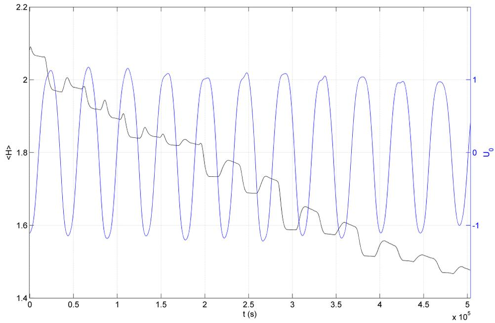
FIGURE E.2 – Évolution temporelle de la hauteur moyenne des dunes et de la vitesse moyenne du courant entre  $t = 0$  s et  $t = 507300$  s,  $k_N = 100d_{50}$ .
