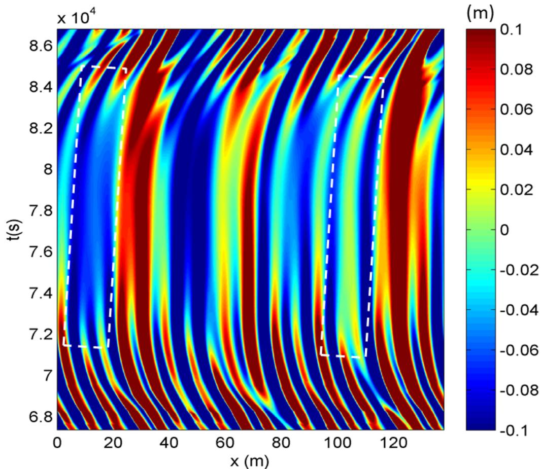
FIGURE 7.6 – Focus sur l'évolution temporelle de la hauteur du fond soumis à un courant tidal entre  $t = 67300$  s et  $t = 86800$  s. La palette de couleurs est resserrée pour mettre en évidence les séquences d'appariements.
