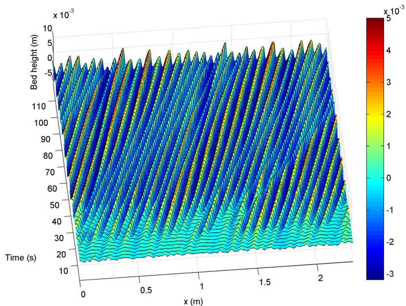
FIGURE C.8 – Évolution temporelle du fond plat faiblement perturbé,  $d = 0.29$  mm,  $Re_p \simeq 11$ .
