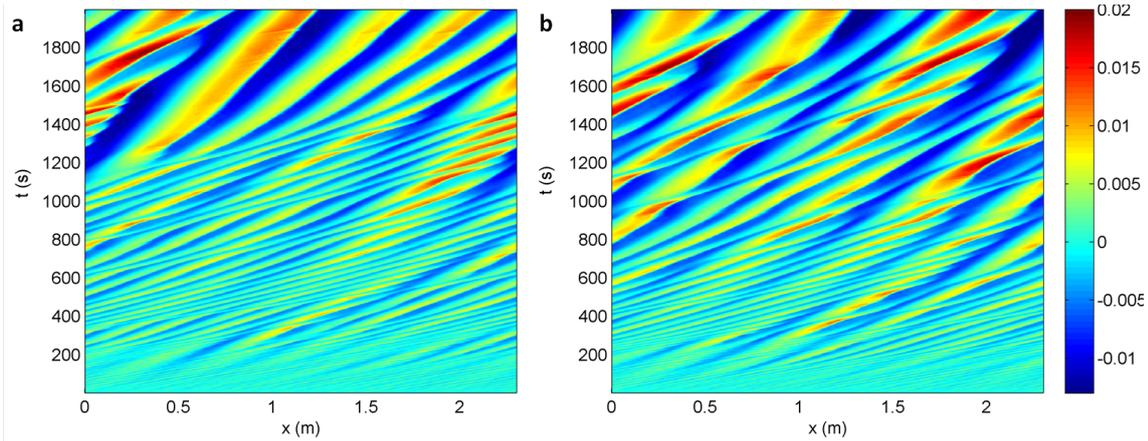
FIGURE 4.29 – Évolution temporelle du fond plat faiblement perturbé pour  $0 \text{ s} < t < 2000 \text{ s}$  sans recirculation des flux de sédiments (a) et avec recirculation des flux de sédiments (b). Modélisation du cas expérimental de *Naqshband et al.* (2014a).
