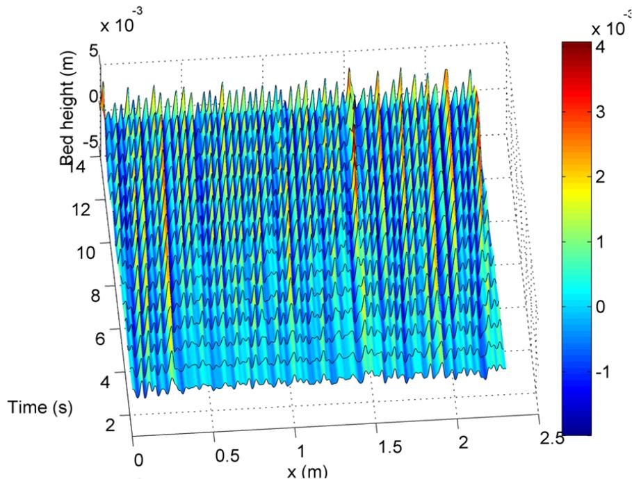
FIGURE C.7 – Évolution temporelle du fond plat faiblement perturbé,  $d = 0.2$  mm,  $Re_p \simeq 7$ .
