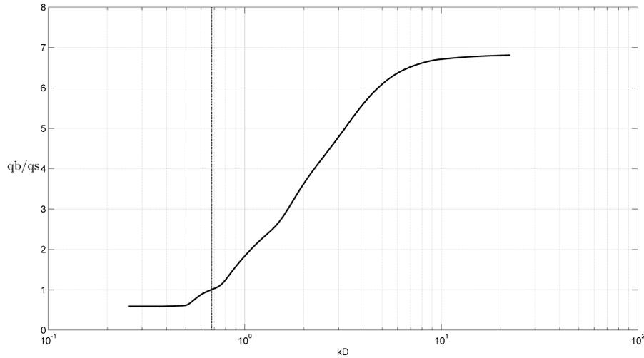
FIGURE 4.25 – Ratio entre le flux par charriage  $q_b$  et le flux en suspension  $q_s$  de crête en fonction de la profondeur adimensionnée  $kD$ . La ligne pointillée correspond à la profondeur adimensionnée pour le champ de dune à l'équilibre dans l'expérimentation de *Naqshband et al.* (2014a).
