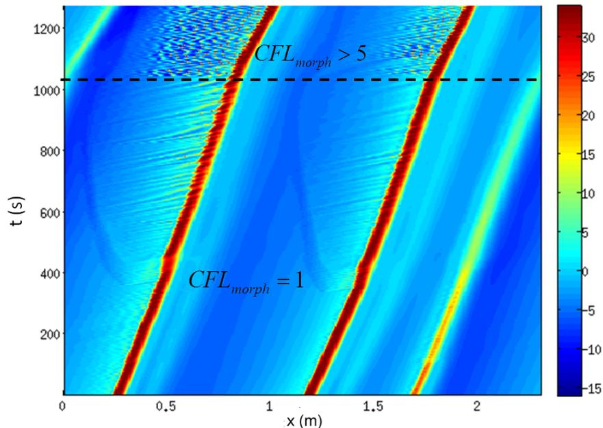
FIGURE 3.8 – Focus sur l'évolution temporelle de la pente de fond simulée pour le cas expérimental de *Naqshband et al.* (2014a) (voir chapitre 4), avec  $CFL_{morph} = 1$  ( $t < 400$  s) et  $CFL_{morph} = 5$  ( $t > 400$  s).
