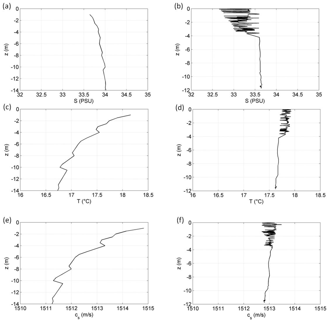
FIGURE D.3 – Courbes de la salinité  $S$  (a et b), de la température  $T$  (c et d), et de la vitesse (e et f) par acquisition câblée et non câblée, respectivement.
