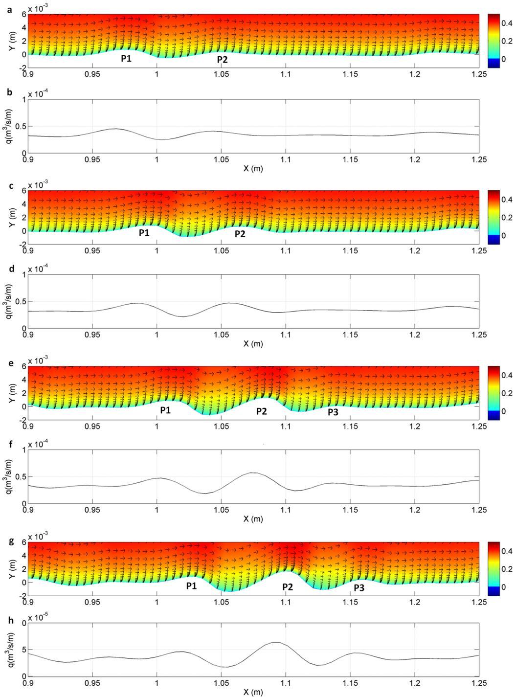
FIGURE 4.16 – Focus sur la séquence de génération d’une perturbation sur le fond. Champs de courants à  $t = 11$  s,  $t = 13$  s,  $t = 15$  s, et  $t = 17$  s (a,c,e,g) et courbe du flux de sédiments par charriage à  $t = 11$  s,  $t = 13$  s,  $t = 15$  s, et  $t = 17$  s (b,d,f,h).
