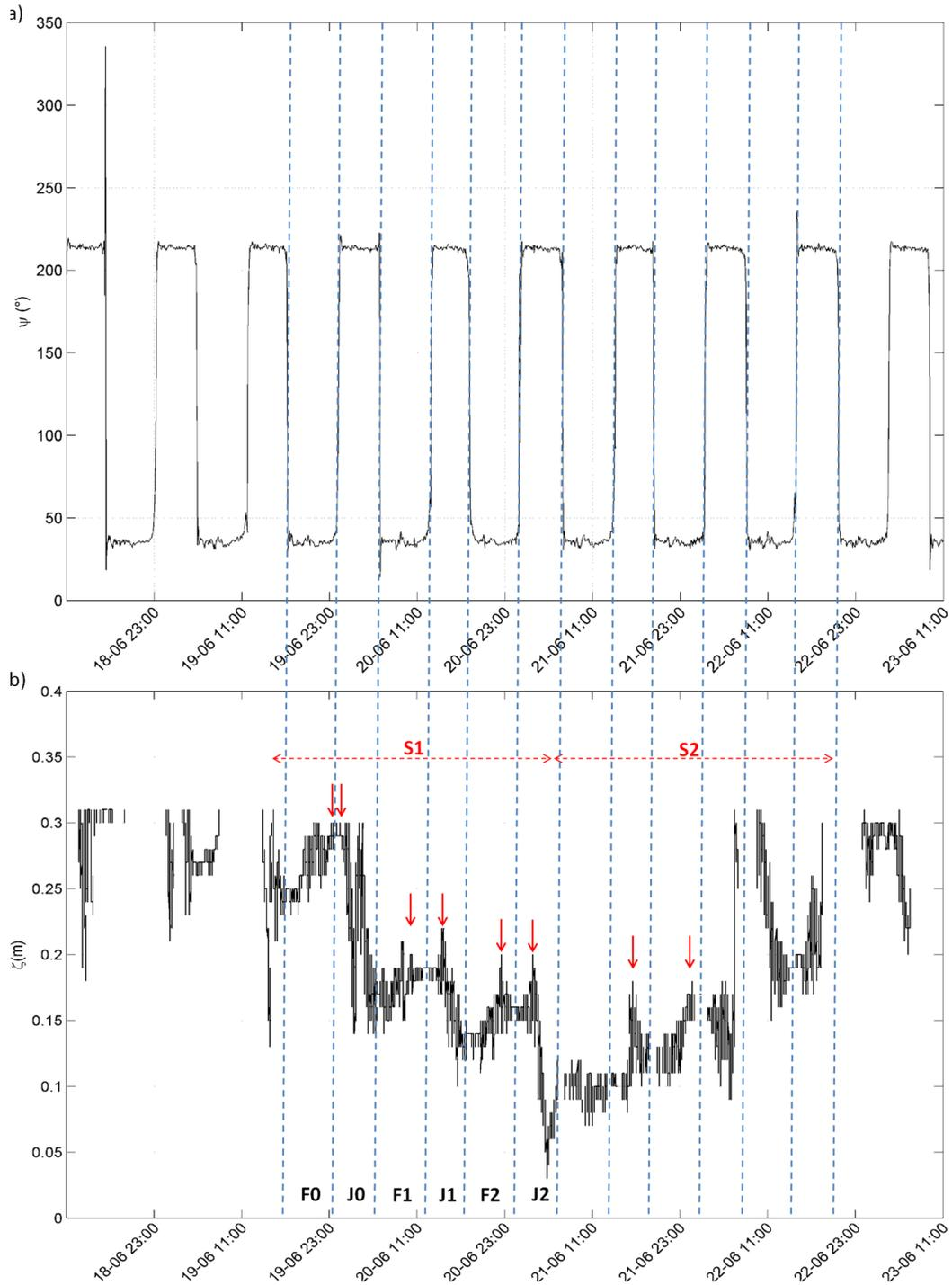
FIGURE 6.39 – Focus sur l'évolution temporelle de la direction moyenne du courant au point de mesures (a) et de la hauteur du fond  $\zeta$  sous le capteur de l'ALTUS (b) entre le 18 Juin 2014 à 11h00 et le 23 Juin 2014 à 11h00.
