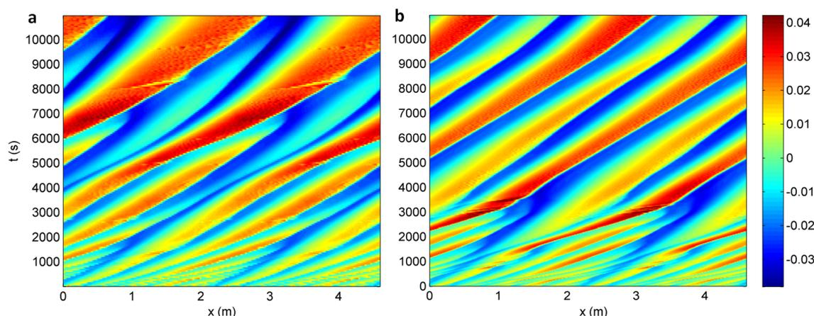
FIGURE 4.26 – Évolution temporelle du fond dans le cas d'un flux de sédiments avec charriage et en suspension (a) et avec charriage seul (b). Modélisation du cas expérimental de *Naqshband et al.* (2014a).
