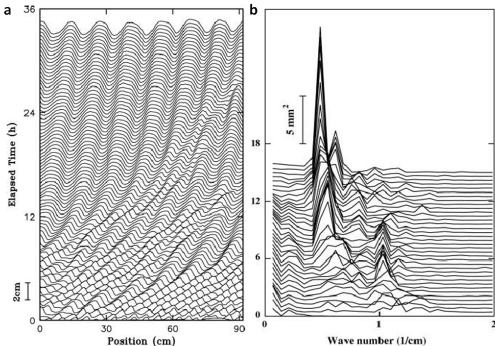
FIGURE 2.9 – Évolution spatio-temporelle de l'interface eau-sable le long du canal (a) et des 30 premiers modes de Fourier ( $d_{50} = 0.95\text{mm}$ ,  $Re_p = 0.71$ ) (b). Figure de *Betat et al.* (2002).
