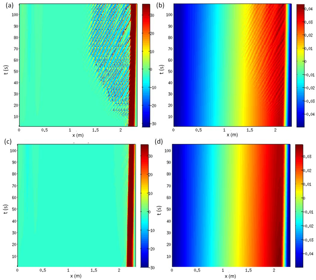
FIGURE 3.7 – Évolution morphodynamique d'un profil triangulaire idéalisé. Évolution temporelle de la pente de fond pour  $CFL_{morph} > 5$  (a) et  $CFL_{morph} = 1$  (c), et évolution temporelle de la hauteur du fond pour  $CFL_{morph} > 5$  (b) et  $CFL_{morph} = 1$  (d).
