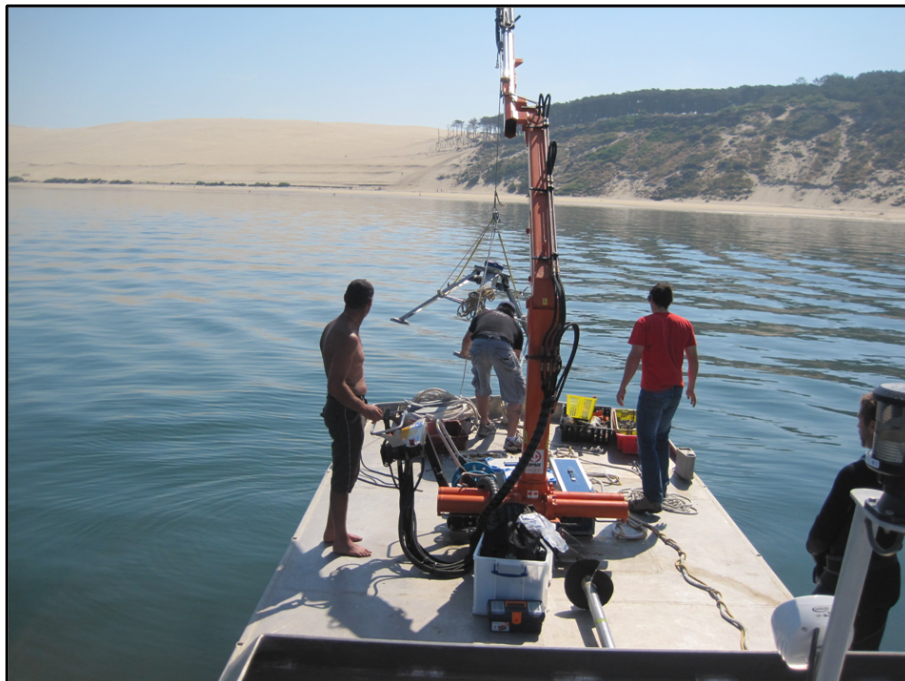
FIGURE D.10 – Image de la mise à l'eau de la structure pyramidale portant l'ADCP et l'ADV.
