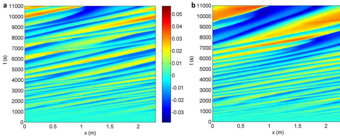
FIGURE 4.30 – Évolution temporelle du fond plat faiblement perturbé pour  $0 \text{ s} < t < 11000 \text{ s}$  sans recirculation des flux de sédiments (a) et avec recirculation des flux de sédiments (b). Modélisation du cas expérimental de *Naqshband et al.* (2014a).
