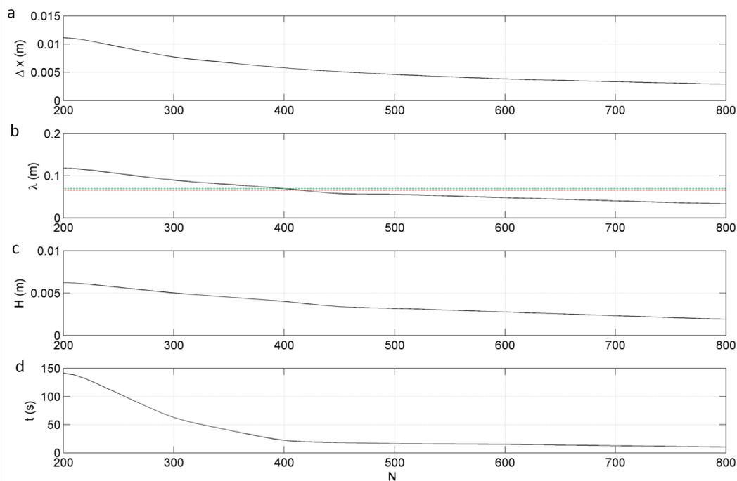
FIGURE 4.15 – Résolution du maillage (a), longueur d'onde et hauteur simulées (b) et (c), et temps d'évolution du champ de rides (d) en fonction du nombre de mailles  $N_x$ , pour un grain de diamètre  $d_{50} = 0.29$  mm. Les lignes pointillées bleue, rouge et verte représentent les longueurs d'ondes données par les modèles mathématiques de *Fourrière et al.* (2010), *Charru* (2013) et la relation de *Coleman et al.* (2003).
