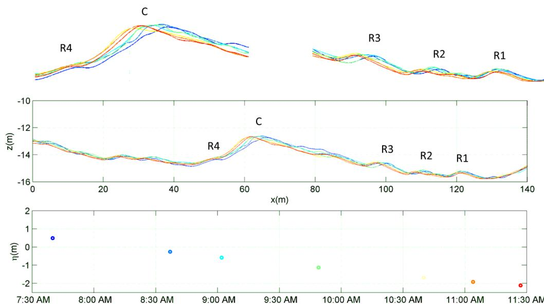
FIGURE 6.34 – Ensemble des transects mesurés lors de la campagne du 13 Juin 2014. 'C' correspond à la position de la crête et les formes surimposées sont numérotées de  $R1$  à  $R4$ .
