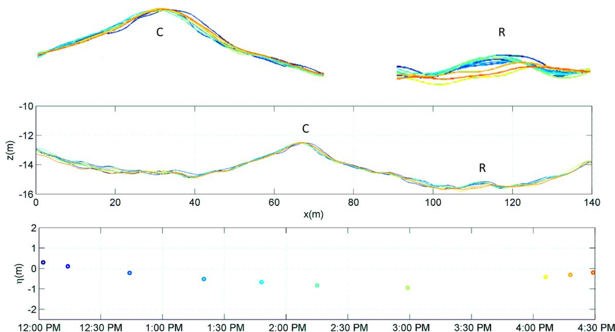
FIGURE 6.31 – Ensemble des transects mesurés lors de la campagne du 24 Septembre 2013. La palette de couleur du bleu au rouge décrit les profils des plus anciens aux plus récents.  $C$  correspond à la position de la crête et  $R$  à une ride surimposée sur le profil.
