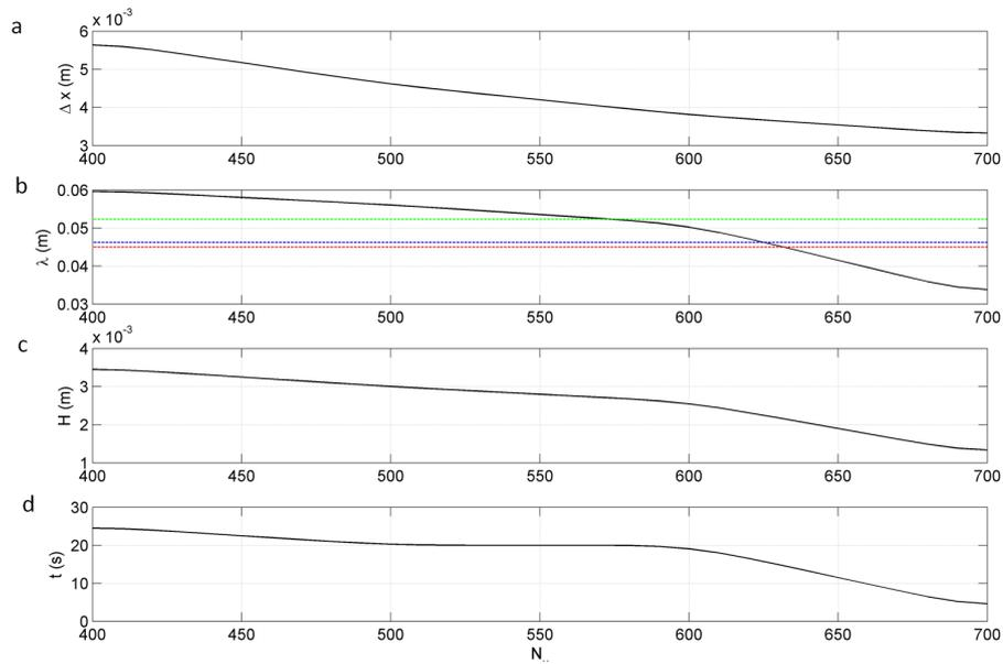
FIGURE C.2 – Résolution du maillage (a), longueur d’onde et hauteur simulées (b) et (c), et temps d’évolution du champ de rides (d) en fonction du nombre de mailles  $N_x$ , pour un grain de diamètre  $d_{50} = 0.2$  mm,  $\theta = 0.2$ . Les lignes pointillées bleue, rouge et verte représentent les longueurs d’ondes données par les modèles mathématiques de *Fourrière et al.* (2010), *Charru* (2006) et la relation de *Coleman et al.* (2003).
