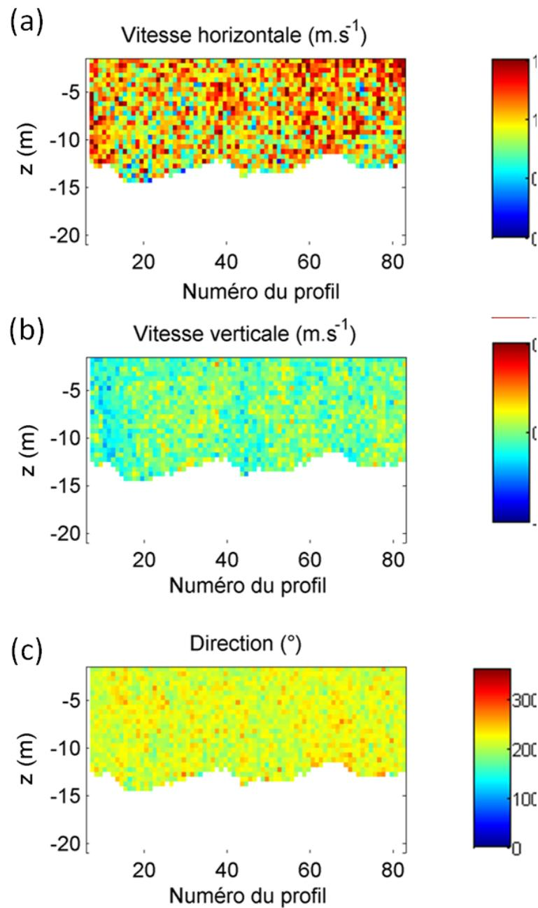
FIGURE D.21 – Vitesse horizontale (a), vitesse verticale (b) et direction du courant (c) mesurées par ADCP le long du profil de deux dunes, le 13/06/2014 à 8h22.
