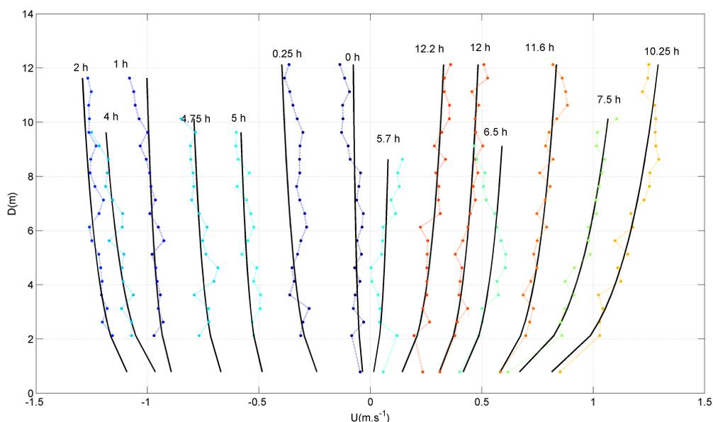
FIGURE 6.14 – Évolution temporelle du profil vertical de la vitesse  $U$  au dessus du point de mesure pour la marée de vives-eaux du 13 Juin 2014. Les courbes de couleur représentent les profils reconstruits à partir des données ADCP et ADV. Les courbes noires sont les courbes de régression logarithmique.
