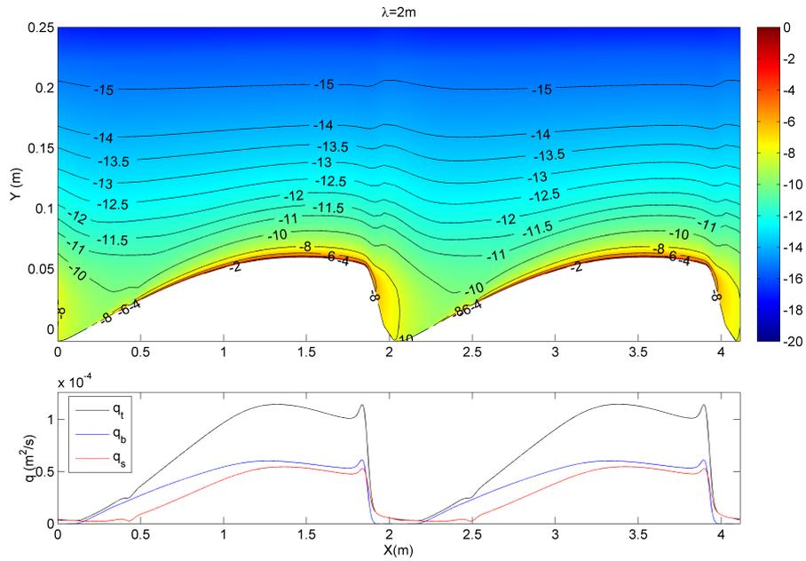
FIGURE C.12 – Champ de concentration de sédiment en suspension  $\ln c$  (haut), et profils de transport par charriage, en suspension et de transport total (bas) pour une longueur d'onde  $\lambda = 2$  m.
