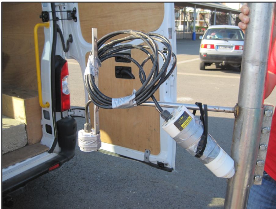
FIGURE D.12 – Image de l'appareillage de l'ALTUS sur la potence de la vrille inox.
