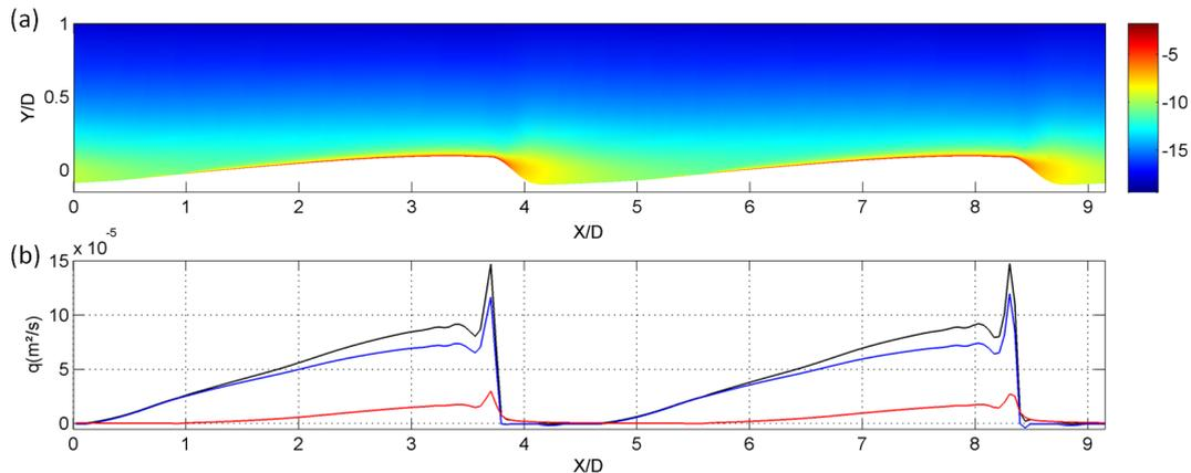
FIGURE 3.5 – Simulation des flux sédimentaires au-dessus d'un champ de dunes asymétrique. Champ de concentration des sédiments en suspension  $c$  (échelle logarithmique) (a) et flux de sédiments par charriage,  $q_b$  (bleu), en suspension,  $q_s$  (rouge), et total,  $q$  (noir) (b).
