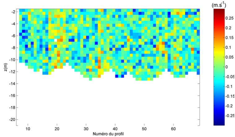
FIGURE 6.32 – Vitesses verticales mesurées au dessus du profil des dunes une heure après l'étape de jusant le 24 Septembre 2013.
