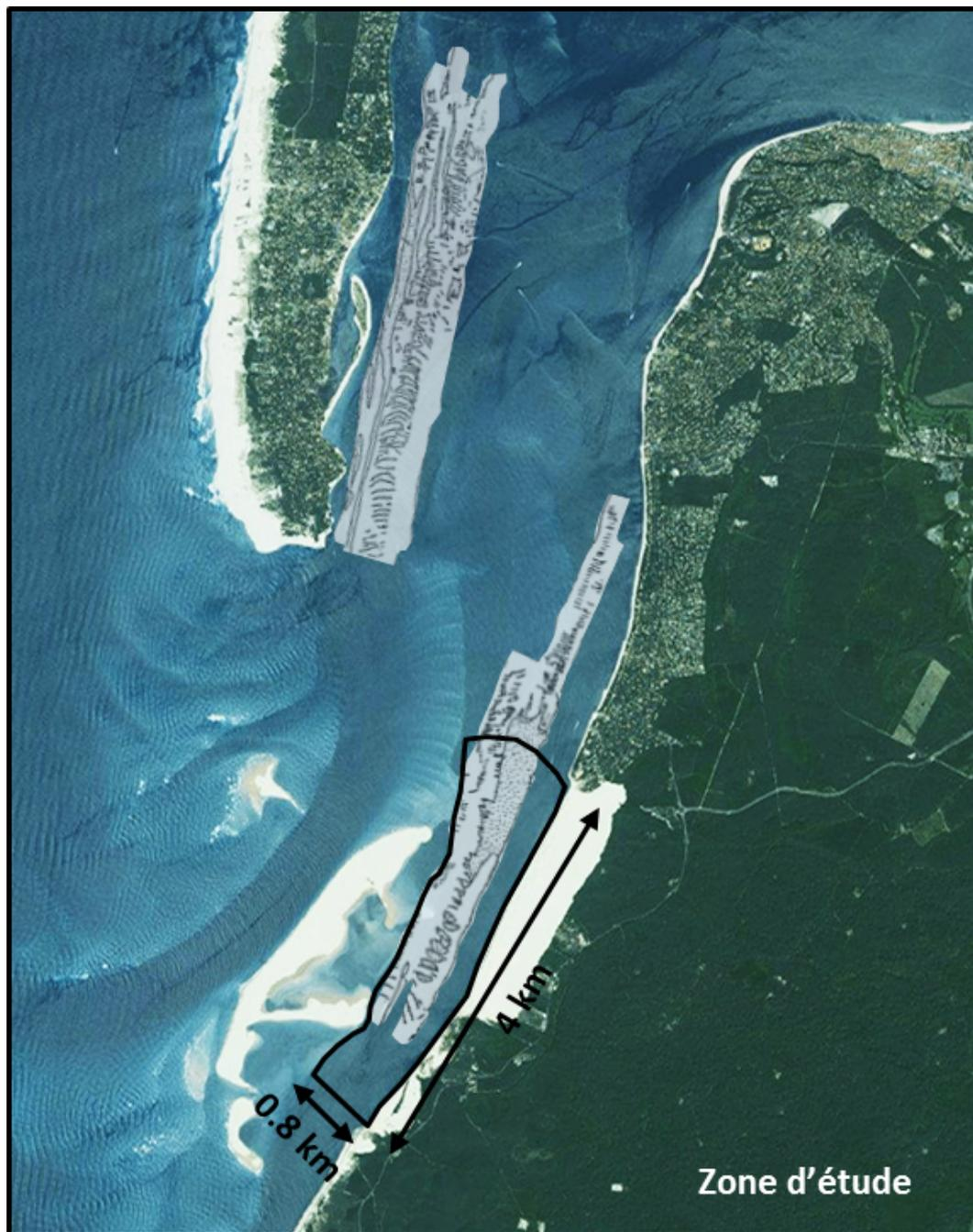
FIGURE 6.4 – Zone d'étude retenue (frontière noire) et champs de dunes détectés par sonar à balayage latéral dans les passes du bassin d'Arcachon lors de la campagne Geodep de 1992 (*Thauront, 1995*).
