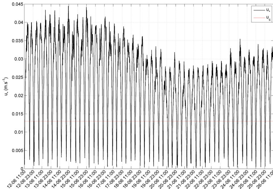
FIGURE 6.18 – Évolution temporelle de la vitesse de cisaillement  $u^*$  pour le cycle de vives-eaux mortes-eaux. La ligne rouge représente le seuil de mise en mouvement pour un sédiment non-cohésif de diamètre médian  $d_{50} = 0.31$  mm.
