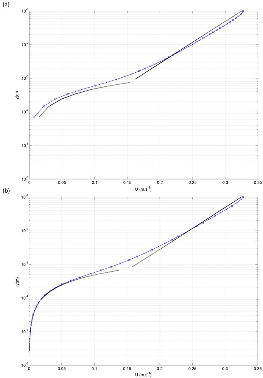
FIGURE 3.12 – Vitesse modélisée avec Dune2D (courbe bleue) et profil de vitesse théorique (pointillés) avec la résolution au fond telle que définie dans Dune2D  $\Delta z = 6.9.10^{-5}$  m (a) et avec la résolution employée dans la nouvelle version,  $\Delta z = 2.7.10^{-6}$  m.
