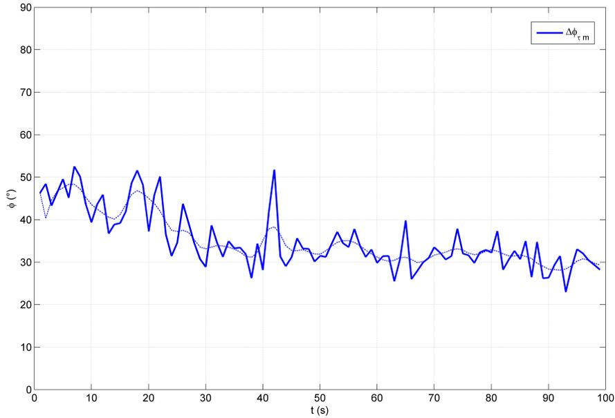
FIGURE 4.19 – Évolution du déphasage moyen du maximum de contrainte de cisaillement,  $\Delta\phi_{\tau m}$ , pendant la phase initiale de génération des rides. La courbe en pointillé représente la moyenne glissante de la courbe de déphasage moyen.
