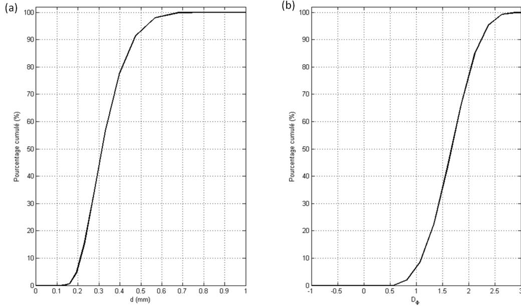
FIGURE 6.23 – Pourcentage cumulé de sédiments en fonctions du diamètre  $d$  (a) et du diamètre  $D_\Phi$  (b) pour l'échantillon prélevé sur le profil de la dune.
