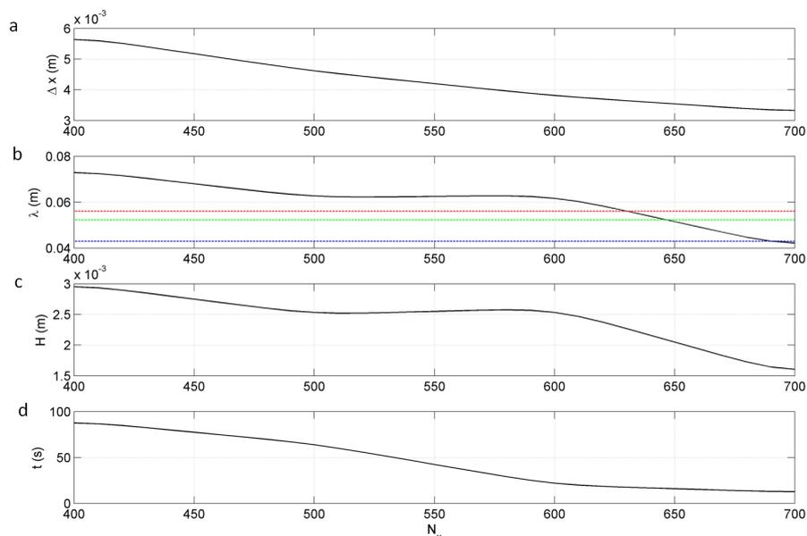
FIGURE C.1 – Résolution du maillage (a), longueur d'onde et hauteur simulées (b) et (c), et temps d'évolution du champ de rides (d) en fonction du nombre de mailles  $N_x$ , pour un grain de diamètre  $d_{50} = 0.2$  mm,  $\theta = 0.1$ . Les lignes pointillées bleue, rouge et verte représentent les longueurs d'ondes données par les modèles mathématiques de *Fourrière et al.* (2010), *Charru* (2006) et la relation de *Coleman et al.* (2003).
