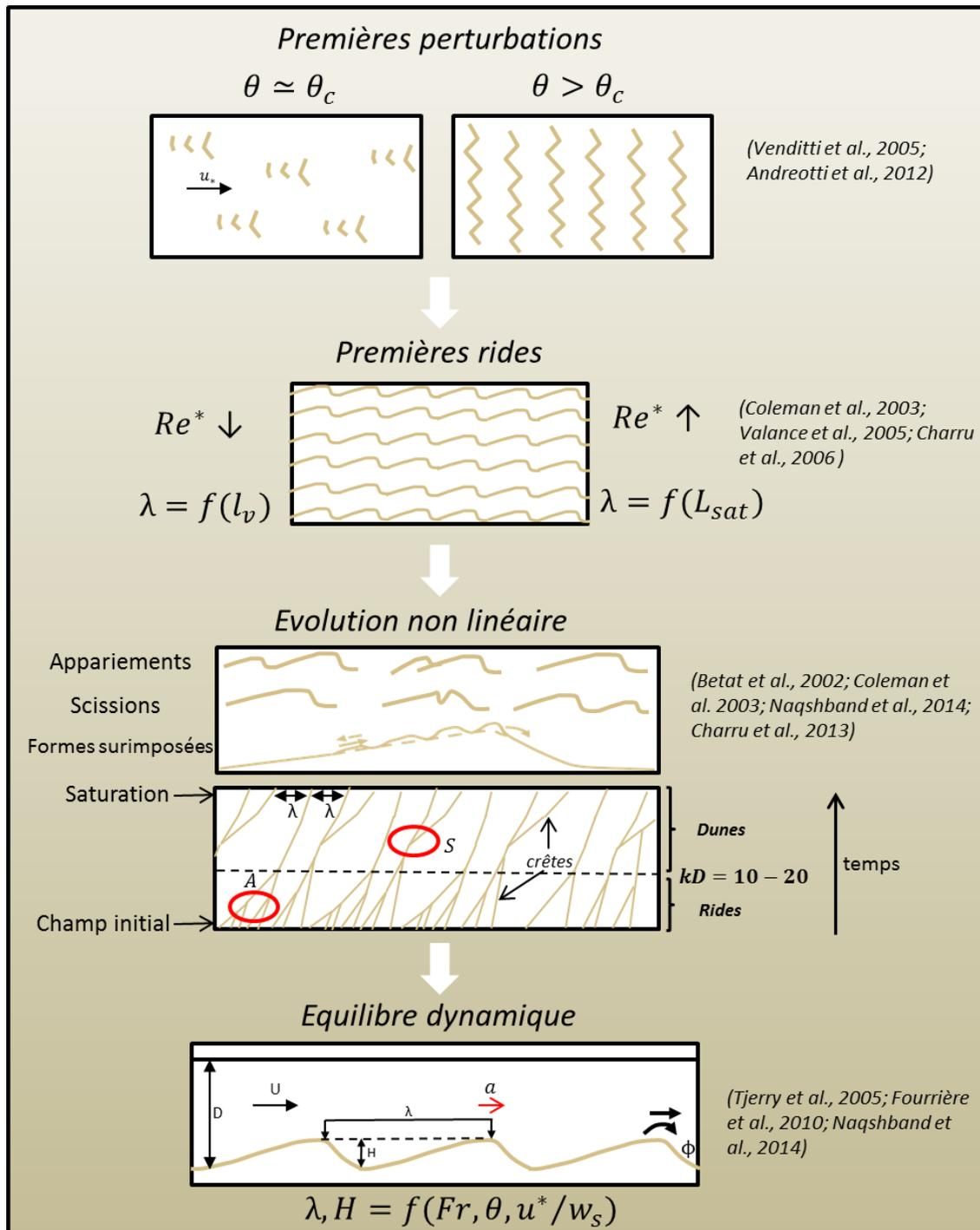
FIGURE 2.16 – Schéma de synthèse de l'évolution du fond faiblement perturbé jusqu'à l'équilibre.
