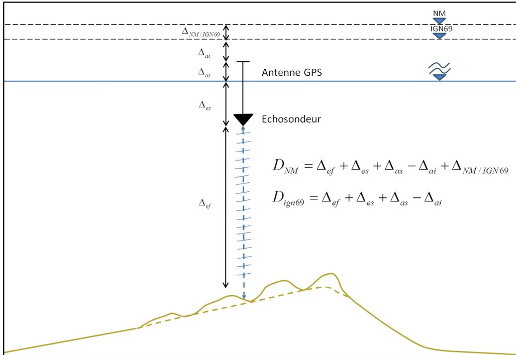
FIGURE D.4 – Schéma de principe de la correction de la profondeur mesurée, par rapport au niveau de référence *IGN69* et au niveau moyen *NM*.  $\Delta_{ef}$ ,  $\Delta_{es}$ ,  $\Delta_{as}$  sont les distances entre le fond et l'échosondeur, l'échosondeur et la surface de l'eau, et l'antenne et la surface de l'eau, respectivement.  $\Delta_{ai}$  et  $\Delta_{NM/IGN69}$  sont la cote de l'antenne GPS et du niveau moyen *NM* par rapport à l'*IGN69*, respectivement.
