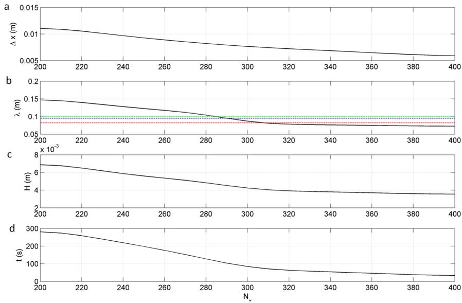
FIGURE C.6 – Résolution du maillage (a), longueur d'onde et hauteur simulées (b) et (c), et temps d'évolution du champ de rides (d) en fonction du nombre de mailles  $N_x$ , pour un grain de diamètre  $d_{50} = 0.5$  mm. Les lignes pointillées bleue, rouge et verte représentent les longueurs d'ondes données par les modèles mathématiques de *Fourrière et al.* (2010), *Charru* (2013) et la relation de *Coleman et al.* (2003).
