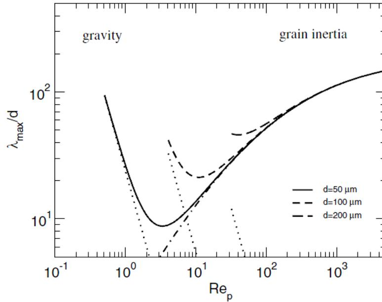
FIGURE 2.5 – Évolution de la longueur d’onde la plus instable,  $\lambda_{max}$ , en fonction de  $Re_p$  pour différents diamètres de grains illustrant les régimes de gravité et d’inertie. Les courbes pointillées et tirets-pointillés correspondent respectivement aux modes les plus instables en l’absence d’effet d’inertie et de gravité. Figure de *Valance et Langlois (2005)*.
