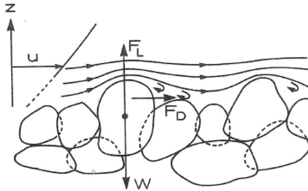
FIGURE 1.4 – Forces agissant sur les grains constituant un lit de sable.  $F_L$  : force de décollement,  $F_D$  : force d'arrachement,  $W$  : poids submergé du grain de sable. Figure de *Fredsæ et Deigaard* (1992).
