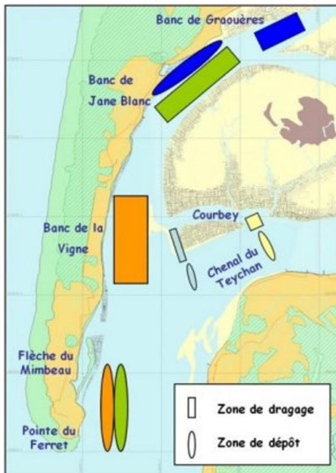
FIGURE D.1 – Principaux sites de dragages et de dépôts dans la bassin d'Arcachon, représentant plus de 2,000,000 de m<sup>3</sup> sur la période 2000-2006. Source : SIBA.
