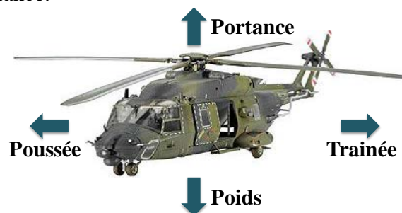
Figure IV.1 : Les quatre forces appliquées à un hélicoptère
