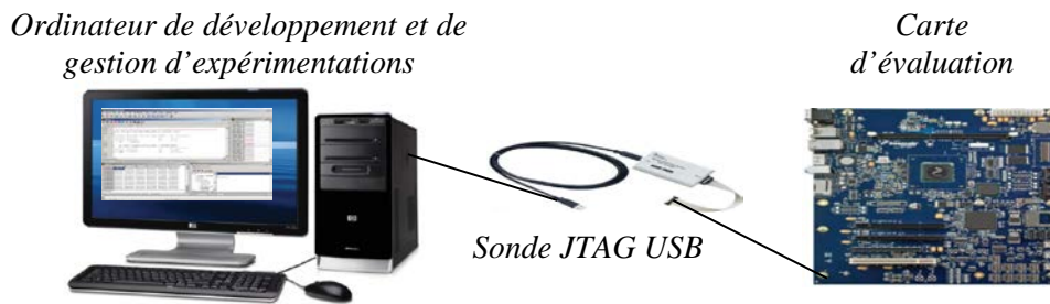
Figure IV.16 : Plateforme d'expérimentations (cas du P2020)
