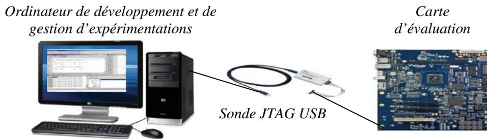
**Figure IV.16 : Plateforme d'expérimentations (cas du P2020)**
