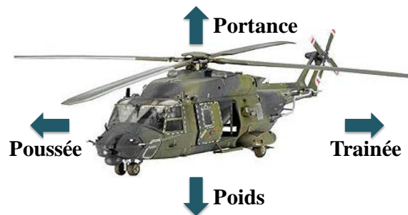
Figure IV.1 : Les quatre forces appliquées à un hélicoptère
