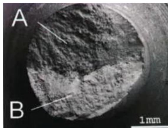
**Figure 78** : Observation au MEB du faciès de rupture d'une éprouvette de 14%Cr rompue en fluage à 650°C après 27380 h sous une contrainte de 330 MPa [50].
