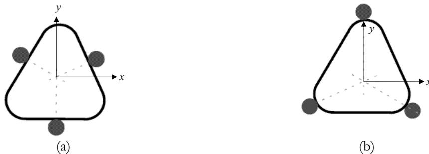
Figure 2.23 : (a) prise fermée géométriquement au 2<sup>nd</sup> ordre, (b) prise non-fermée géométriquement [Rimon et Burdick, 1996].
