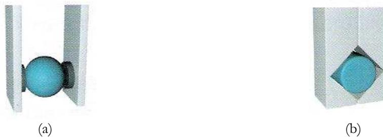
**Figure 1.10 : (a) Pince à verrouillage de force, (b) pince à verrouillage de formes [Wolf *et al.*, 2005].**
