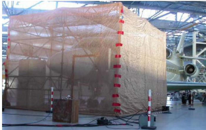
Figure 1.2 – CR en toile métallisée pour test d'immunité du cockpit [5].
